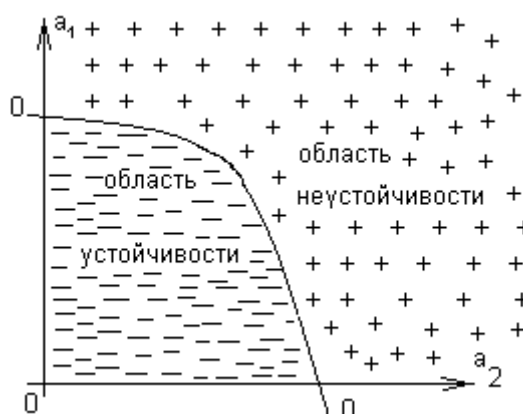
Рисунок 3.2.2 – Область устойчивости в плоскости a_1 и a_2
