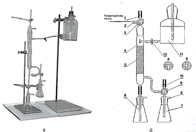
Рисунок 30. Абсорбционная установка:
