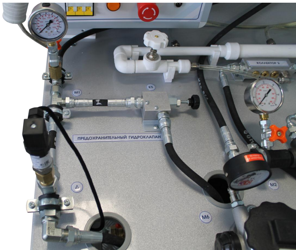
Рисунок 9 - Предохранительный гидроклапан, входная напорная магистраль
