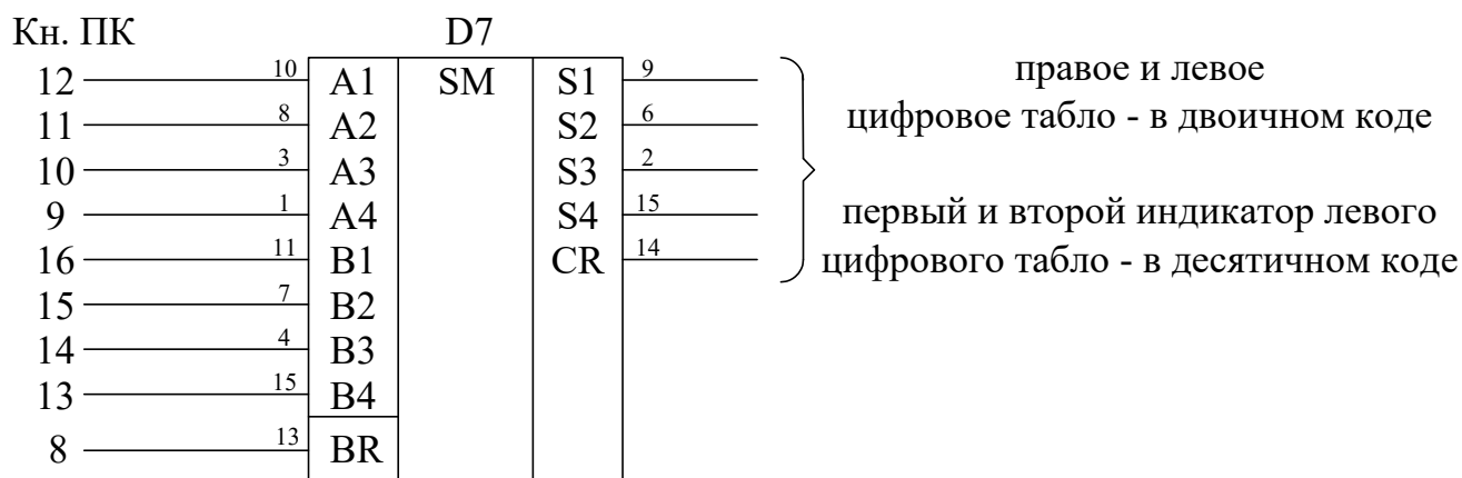
Рисунок 7.4 – Функциональная схема установки для исследования цифрового сумматора
