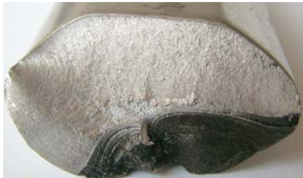
Рисунок 1.1 – Виды изломов: а) – вязкий; б) – хрупкий; в) – усталостный
