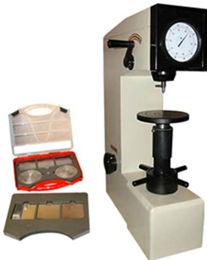
Рисунок 4.3 – Общий вид лабораторной установки для определения твёрдости по методу Роквелла.
