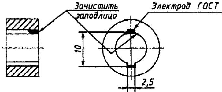
Рисунок 2.4 – Пример обозначения при ремонте наплавкой
