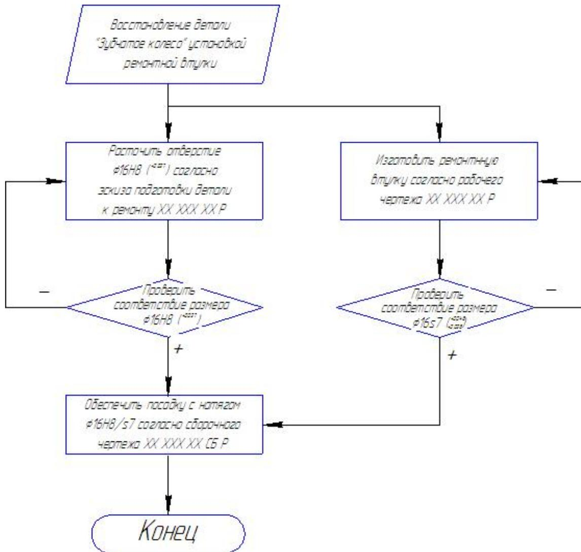
Рисунок 1.2 – Пример блок-схемы алгоритма ремонта детали
