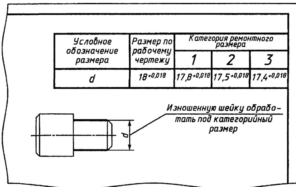
Рисунок 2.7 – Указание на чертеже категориального размера
