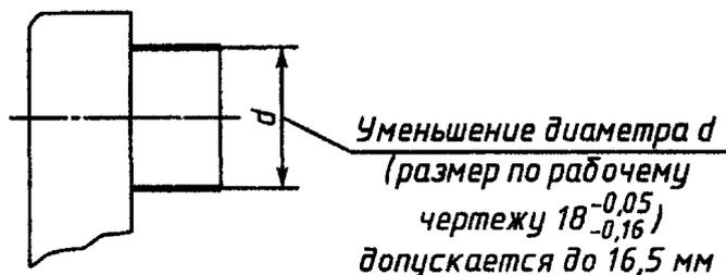
Рисунок 2.6 – Указание на чертеже пригоночного размера
