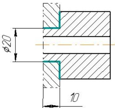
Рисунок 2.5 – Изображение удаляемой части детали на эскизе подготовки детали к ремонту
