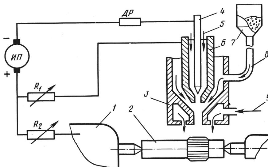
Рисунок 4.1 – Схема установки для плазменной наплавки с вдуванием порошка в дугу: 1 – токарный станок; 2 – деталь; 3 – внешнее сопло; 4 – вольфрамовый электрод (катод); 5 – плазмообразующий газ аргон; 6 – внутреннее сопло; 7 – бункер для порошка; 8 – порошок; 9 – защитный газ
