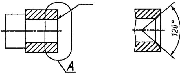
Рисунок 2.3 – Выноска, выделяющая ремонтный участок детали
