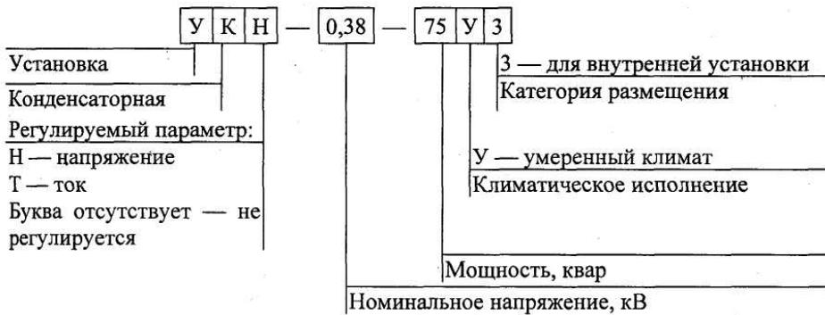
Рис. 8.1. Структурная схема условного обозначения компенсирующего устройства
