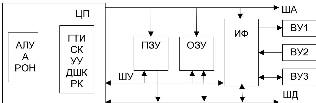
Рисунок 5 – Микропроцессорная система
