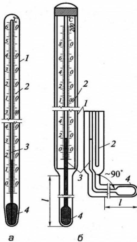
Рис. 2.2. Жидкостные стеклянные термометры: а – палочный; б – технический со вложенной шкалой; 1 – стеклянная оболочка; 2 – шкала; 3 – капиллярная трубка; 4 – запасной резервуар
