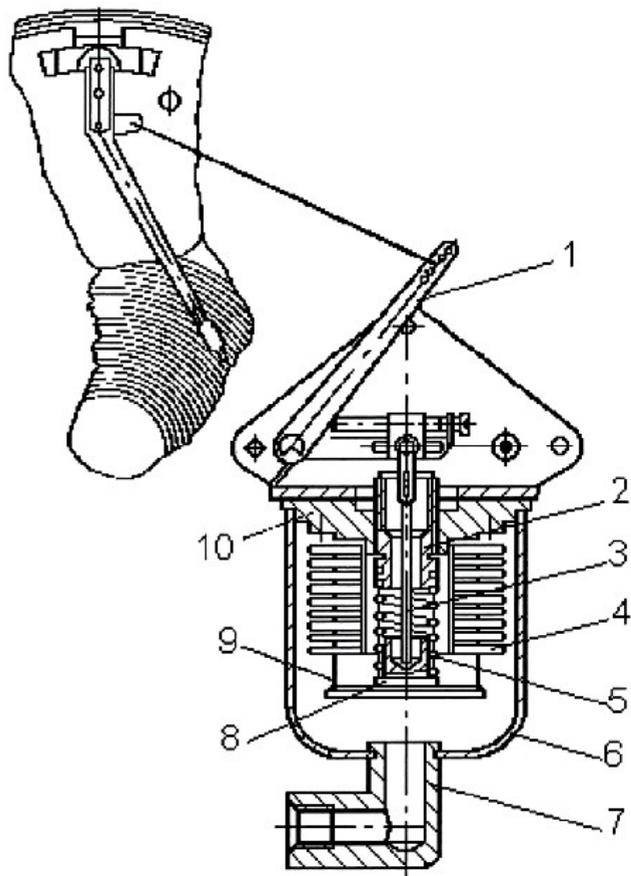
Рис. 4.4. Сифонный самопишущий манометр с рычажным передаточным механизмом:
