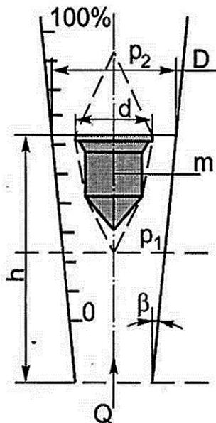
Рис. 6.3. Схема ротаметра
