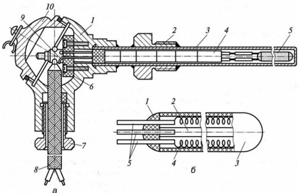
Рис. 2.6. Термометр сопротивления
