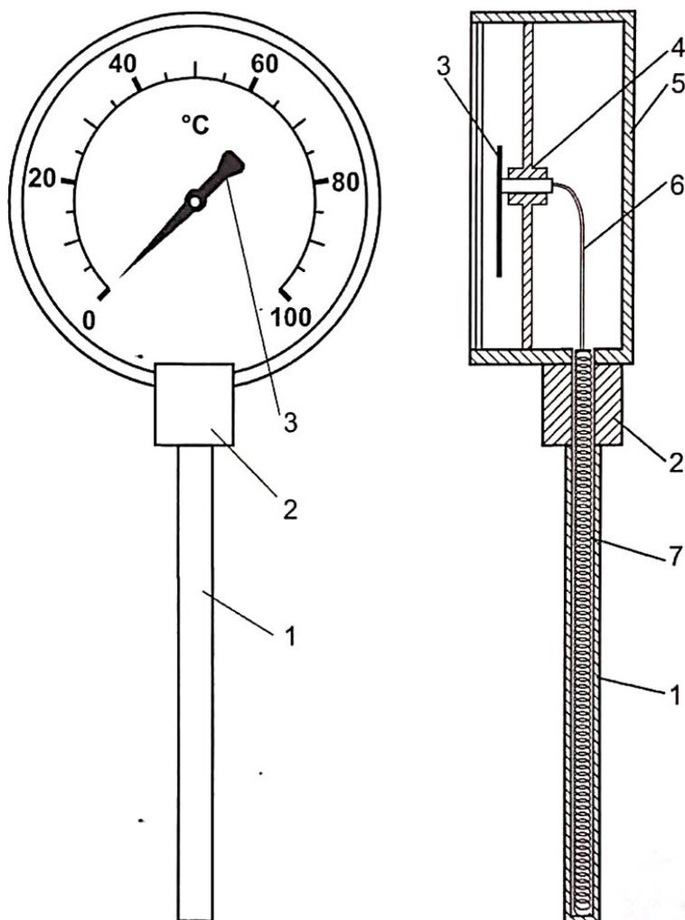
Рис. 2.4. Биметаллический термометр
