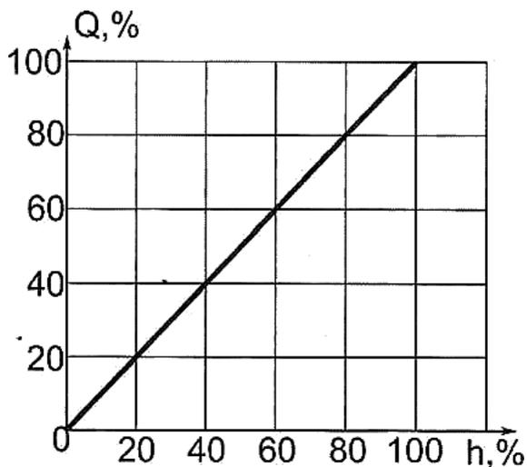
Рисунок 6.4. Зависимость расхода от высоты подъема поплавка
