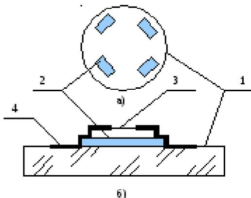
Рис. 4.6. Тензорезисторный преобразователь давления: а) вид сверху;
