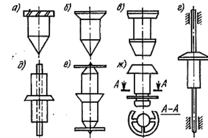
Рис. 6.2. Формы поплавков
