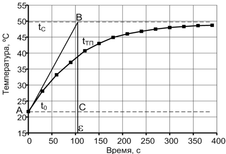
Рис. 3.5. Изменение температуры теплоприемника во времени
