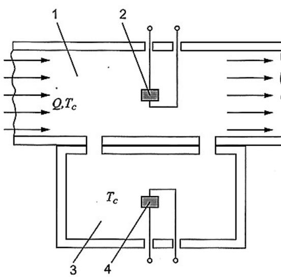
Рис. 6.5. Термоанемометр
