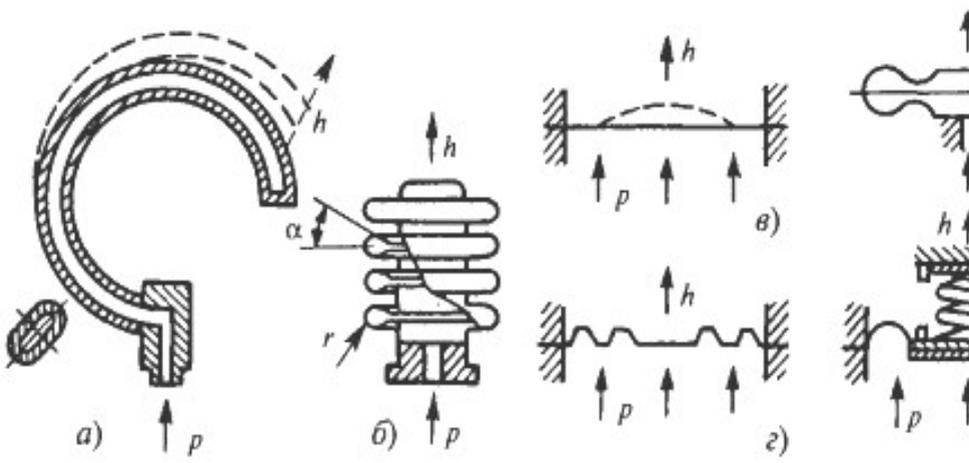
Рис. 4.1. Упругие чувствительные элементы деформационных манометров:
