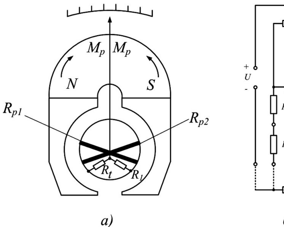
Рис. 3.3. Устройство магнитоэлектрического логометра
