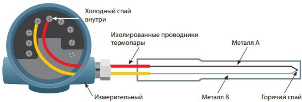
Рисунок 2.5. Термопара
