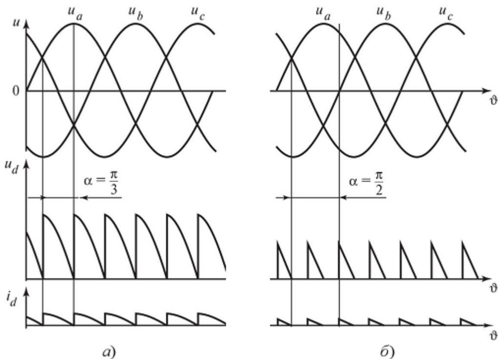
Рис. 4 – Диаграммы напряжений и токов при  $\alpha = \pi/3$  (а) и  $\alpha = \pi/2$  (б)
