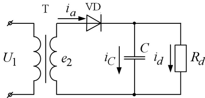
Рис. 2 – Работа выпрямителя на активно-емкостную нагрузку
