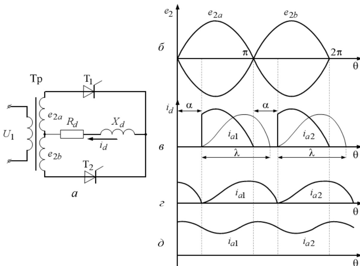
Рис. 4 – Двухполупериодный управляемый выпрямитель со средней точкой
