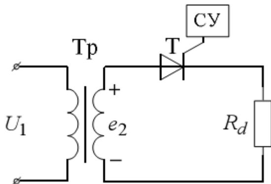
Рис. 1 – Однофазный однополупериодный управляемый выпрямитель
