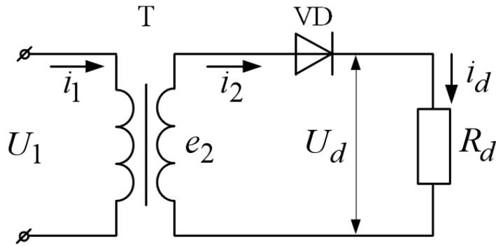
Рис. 1 – Однофазная, однополупериодная схема выпрямления
