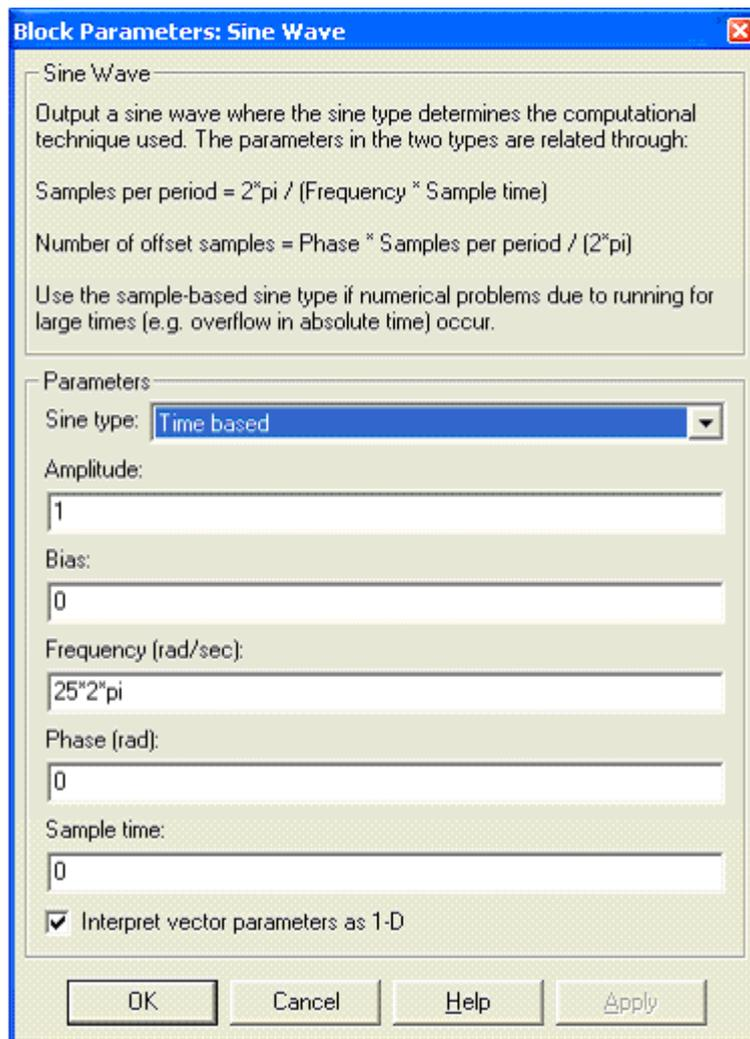
Рис. 8 – Окно настройки блока Sine Wave
