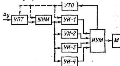
Рисунок 2 – Схема ШИП
