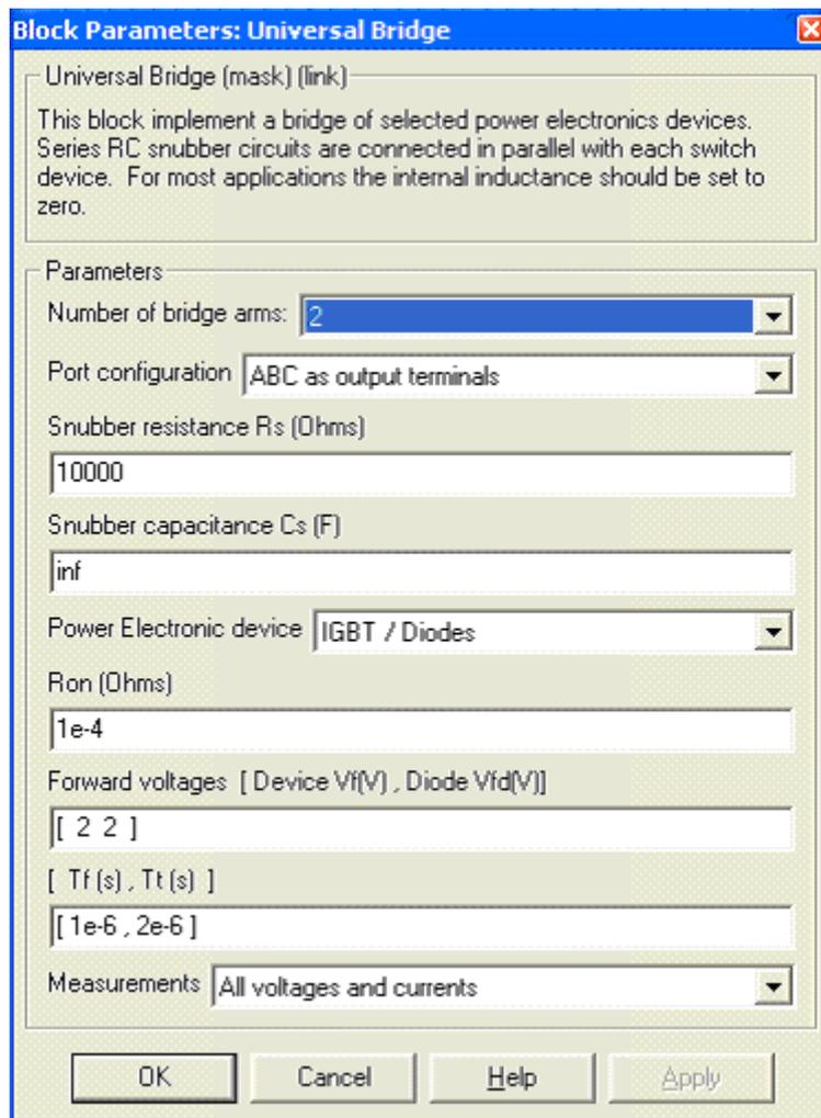
Рис. 5 – Окно параметров блока Universal Bridge
