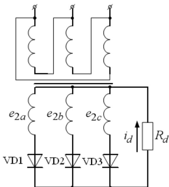
Рис. 2.1 – Трехфазный однотоктный выпрямитель с нулевой точкой
