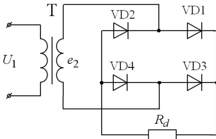
Рис. 5 – Схема Греча
