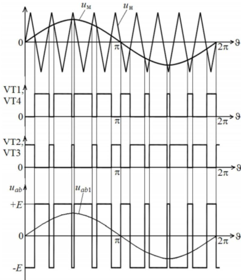
Рис. 2. Принцип формирования управляющих импульсов при двухполярной ШИМ
