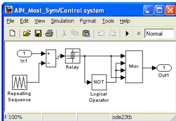
Рис. 6 – Модель блока управления Control system
