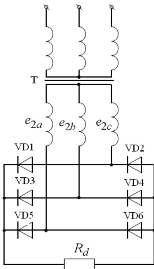
Рис. 2.2 – Трехфазный двухтактный выпрямитель (схема Ларионова)
