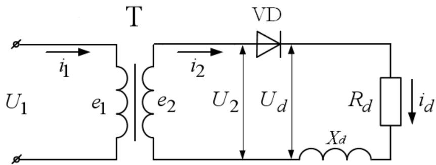
Рис. 3 – Работа выпрямителя на активно-индуктивную нагрузку
