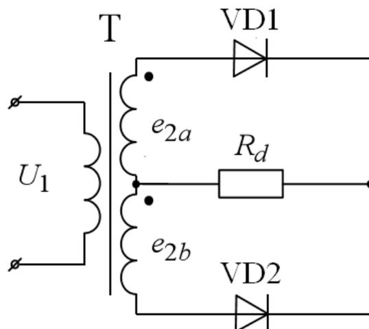
Рис. 4 – Двухполупериодная схема выпрямления со средней точкой
