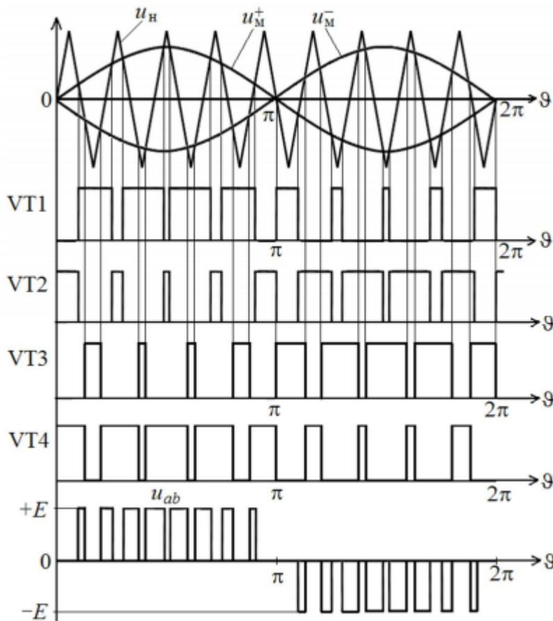
Рис. 3. Принцип формирования управляющих импульсов при однополярной ШИМ
