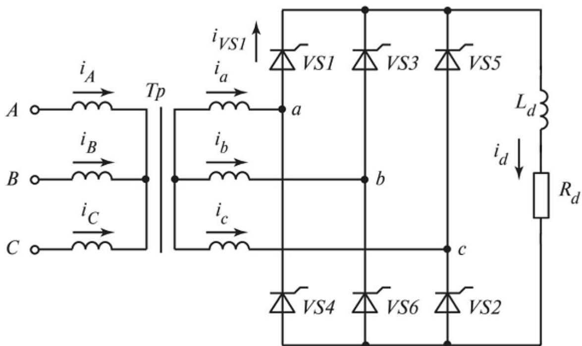
Рис. 1 – Схема трехфазного мостового управляемого выпрямителя
