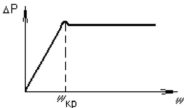
Рисунок 2 Зависимость перепада давления от скорости газового потока.
