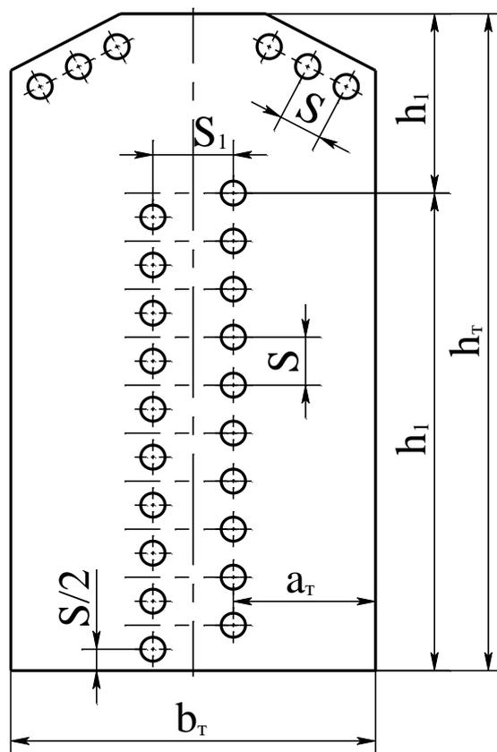
Рисунок 3.3 – Схема к определению размеров камеры радиации
