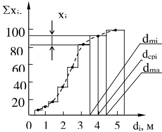
Рис. 1. Интегральная кривая (---) распределения частиц дискретной полидисперсной системы по размерам.
