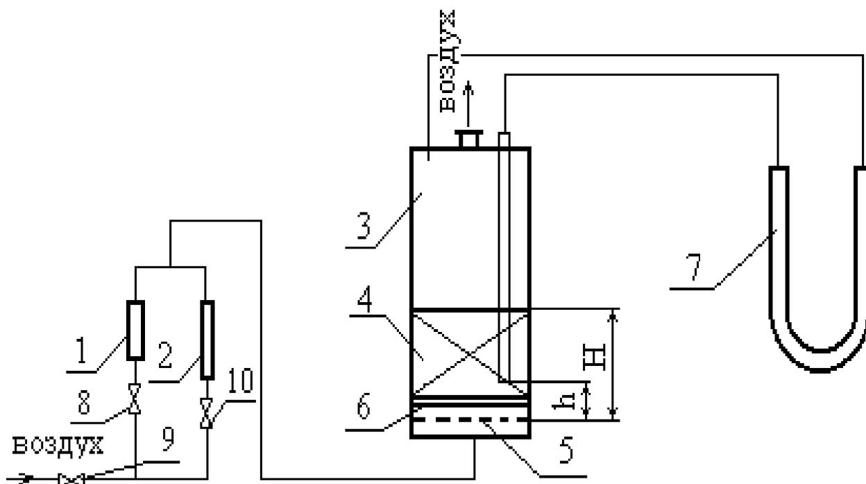
Рисунок 6 Схема лабораторной установки: 1, 2 – ротаметры; 3 – цилиндр; 4 – слой зерненного материала; 5 – металлическая сетка; 6 – распределительное устройство; 7 – U-образный манометр; 8, 9, 10 – вентили.
