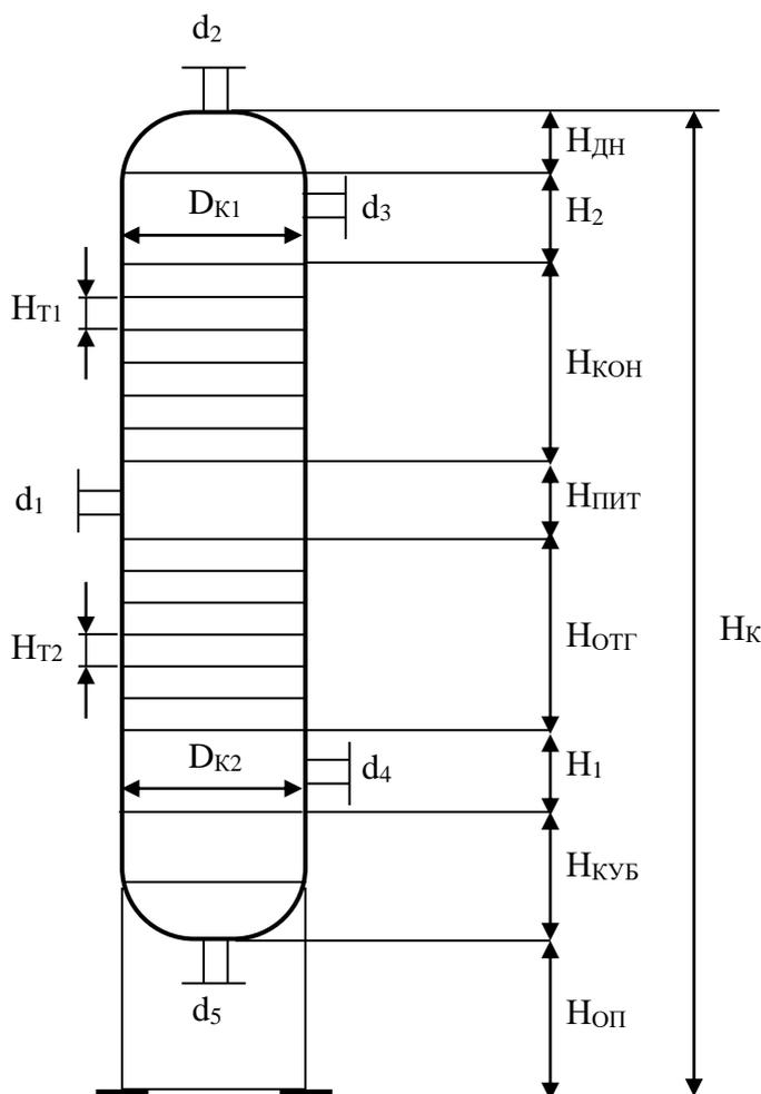
Рисунок 4.2 – Схема к расчету высоты колонны
