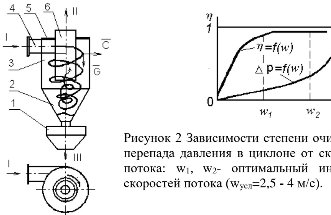
Рисунок 2 Зависимости степени очистки и перепада давления в циклоне от скорости потока:  $w_1, w_2$ - оптимальный интервал скоростей потока ( $w_{усл}=2,5 - 4$  м/с).
