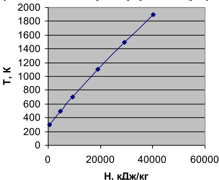
Рисунок 3.2 – График зависимости «энтальпия продуктов сгорания – температура»
