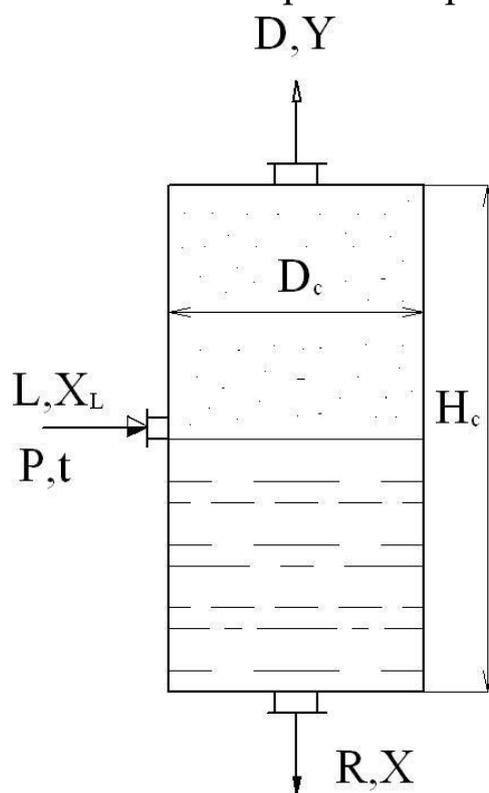
Рисунок 4.1 – Схема однократной перегонки
