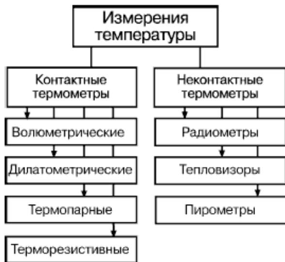
Рис.2.1. Классификация методов измерения температуры
