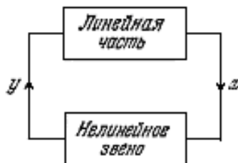
Рисунок 18 — Структурная схема нелинейной АСР
