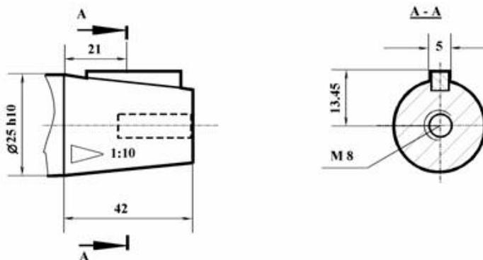
Рисунок 6.3 – Размеры входного вала редуктора Ч-80
