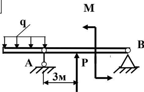
$q = 1 \text{ кН/м}; P=3\text{кН}; M=2 \text{ кН м}$
