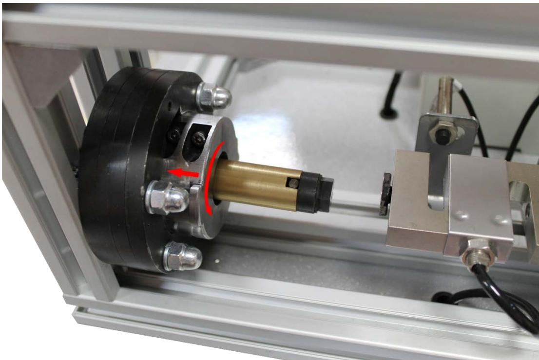
Рисунок 6. Установка втулки с валом в прессовое устройство
