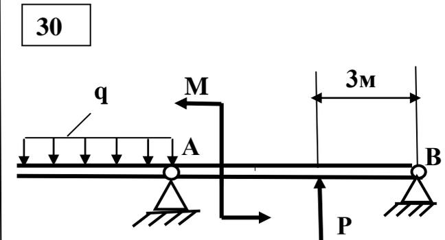
$$q = 1 \text{ кН/м}; P=1 \text{ кН}; M=3 \text{ кН}\cdot\text{м}$$
