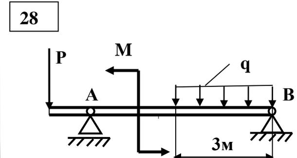
$$q = 2 \text{ кН/м}; P=4 \text{ кН}; M=2 \text{ кН}\cdot\text{м}$$
