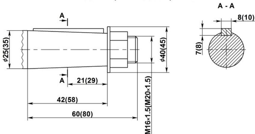
Рисунок 6.3 – Размеры входного (выходного) вала редуктора 1ЦУ-100
