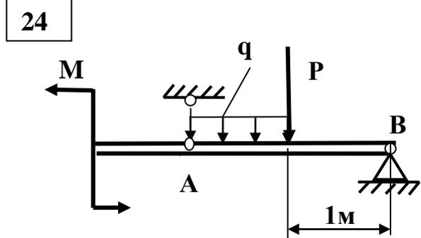
$$P = 2 \text{ кН}; q=2\text{кН}\cdot\text{м}; M=1\text{кН}\cdot\text{м}$$
