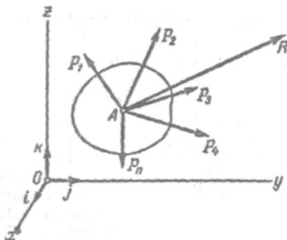
Рисунок 5.6 - Схема определения равнодействующей для n сил
