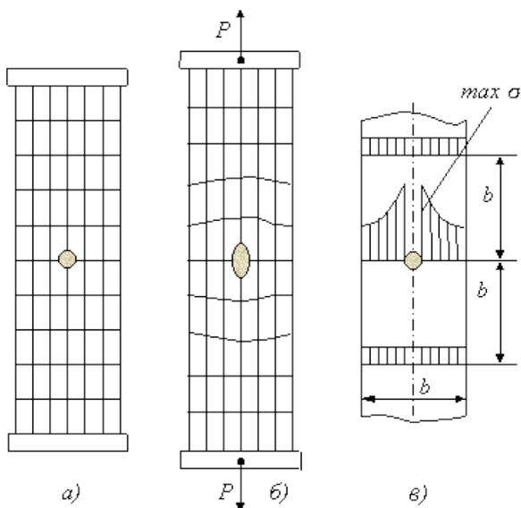
Рисунок 4.2 – Концентрация напряжений:
