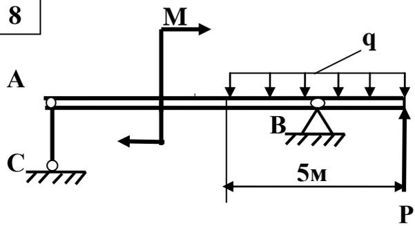
$P = 1 \text{ кН}; q=1\text{кН/м}; M=4\text{кН м}$
