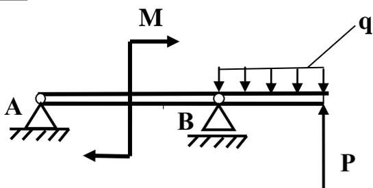
$P = 3 \text{ кН}; q=2\text{кН/м}; M=7 \text{ кН м}$
