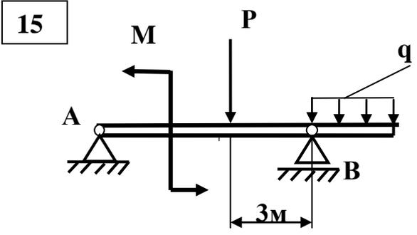
$P = 3 \text{ кН}; q = 1,5 \text{ кН/м}; M = 3 \text{ кН м}$
