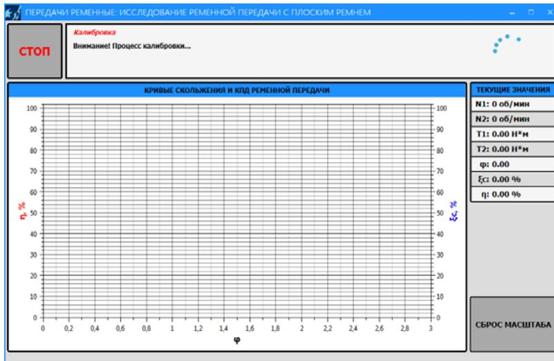
После завершения калибровки начнется процесс выполнения эксперимента: начнется отображение данных, полученных с датчиков, и построение графиков (кривые скольжения и КПД
