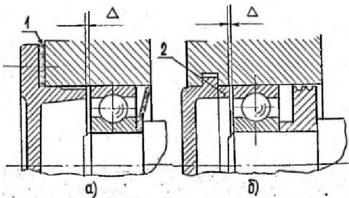
Рисунок 4 – Привертные и закладные крышки подшипников
