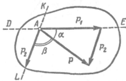
Рисунок 5.3 - Схемы определения векторов составляющих равнодействующей силы
