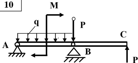
$P = 2 \text{ кН}; q=2\text{кН}\cdot\text{м}; M=4\text{кН м}$
