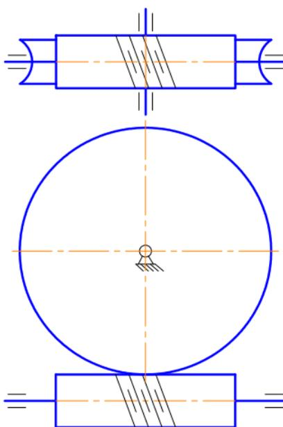
Рисунок 7. Обозначение червячного редуктора в кинематических стендах.
