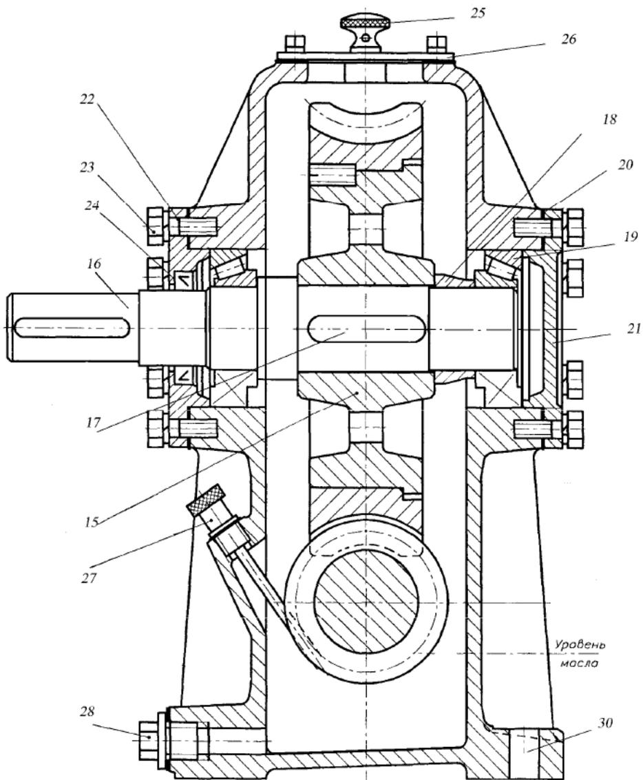
Рисунок 5.7 – Редуктор червячный одноступенчатый
