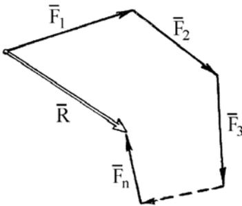
Рис.5.1. Замкнутый многоугольник векторов сил моментов пары сил
