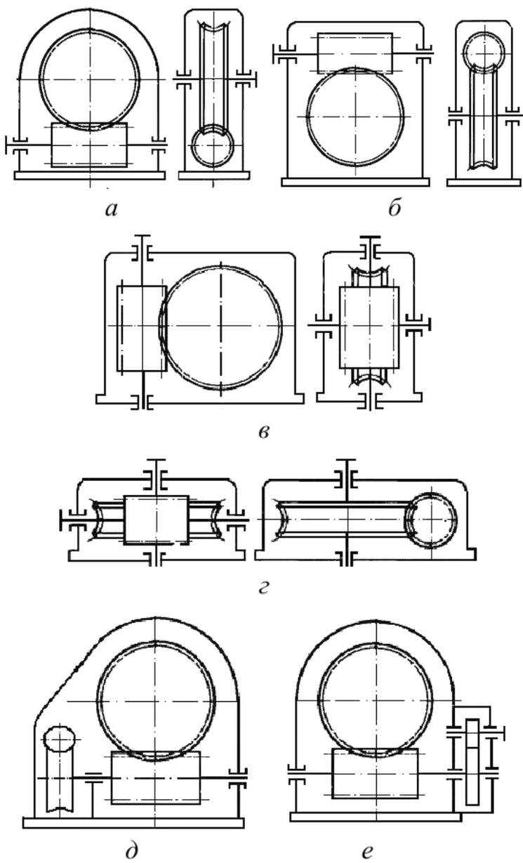
Рисунок 5.2 – Схемы редукторов с червячным зацеплением
