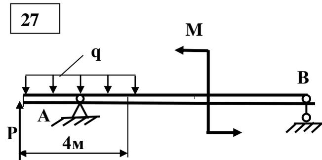
$$P = 2 \text{ кН}; q=2\text{кН}\cdot\text{м}; M=6 \text{ кН}\cdot\text{м}$$
