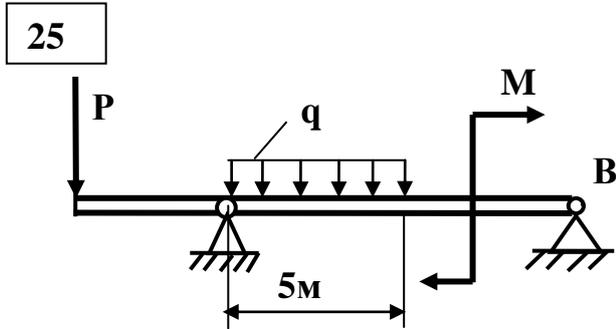
$$q = 1 \text{ кН/м}; P=3 \text{ кН}; M=2 \text{ кН}\cdot\text{м}$$
