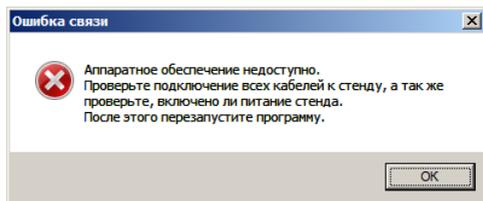
Убедитесь в правильности подключения стенда (на стенд подано питание, стенд включен, преобразователь USB - RS485 подключен к ПК и стенду) и повторите попытку.
