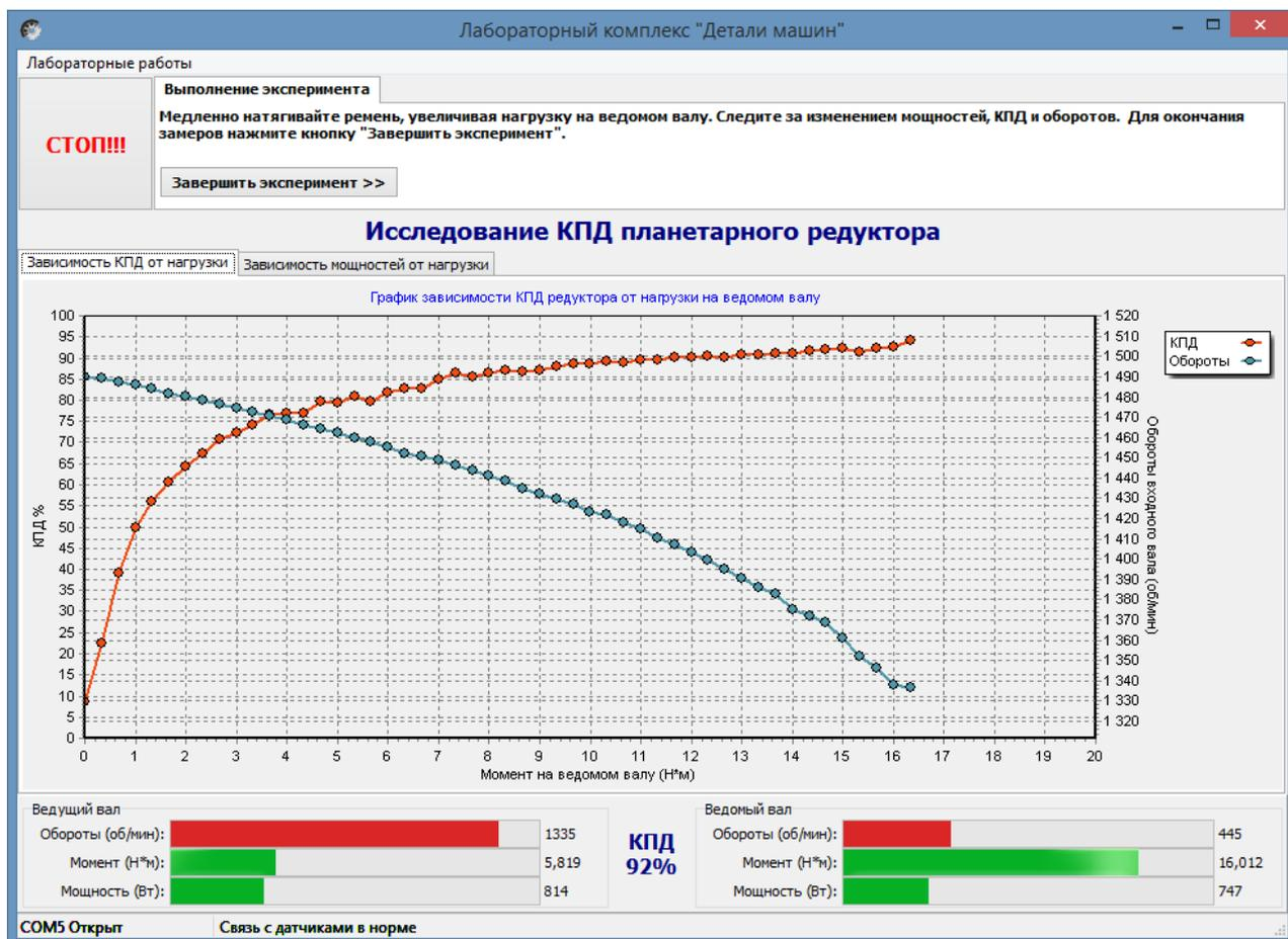
Рисунок 11. Лабораторная работа «Исследование КПД планетарного редуктора»
