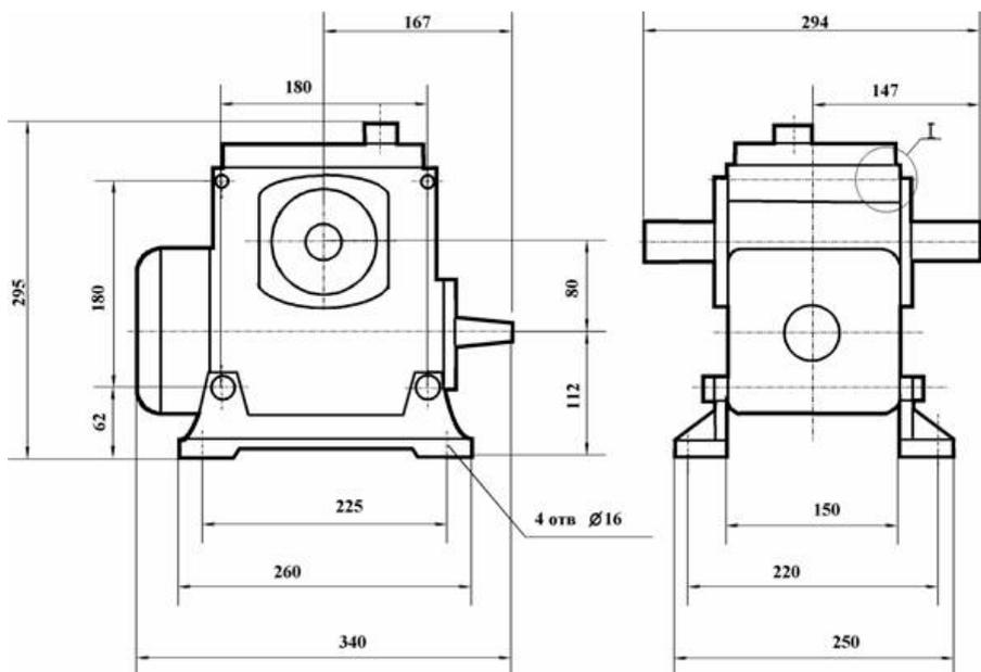
Рисунок 6.2 – Габаритные и присоединительные размеры редуктора Ч-80
