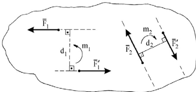
Рис.5.4. Схемы определения направлений действия моментов пар сил
