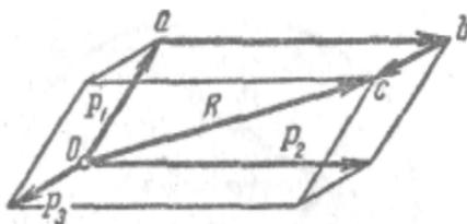
Рисунок 5.5 - Схема определения равнодействующей трех сходящихся сил, не лежащих в одной плоскости
