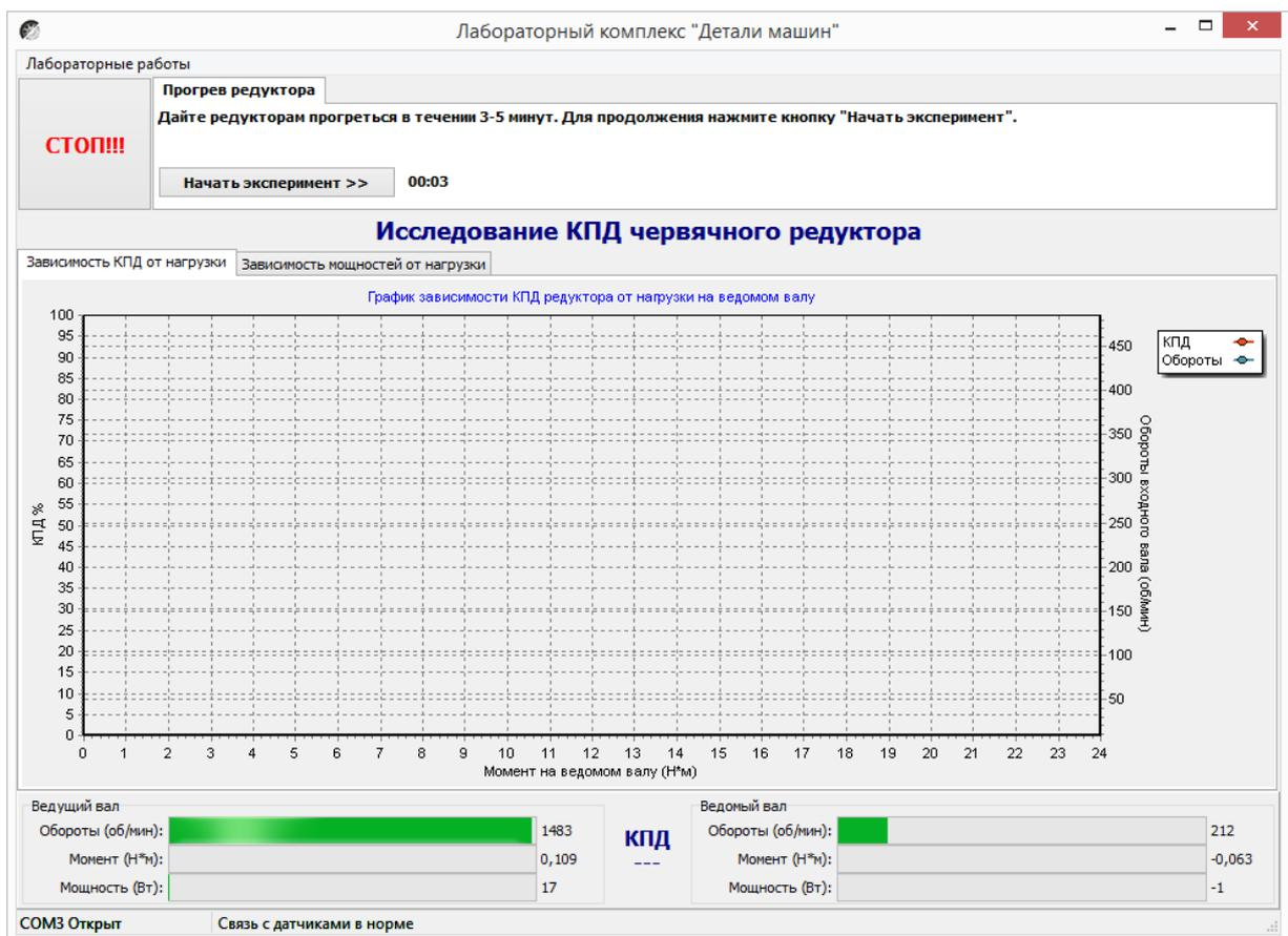
Рисунок 10. Лабораторная работа «Исследование КПД червячного редуктора»
