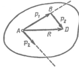
Рисунок 5.1 - Схема определения вектора равнодействующей силы параллелограмма
