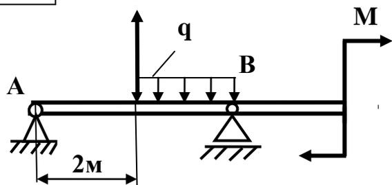
$P = 1,5 \text{ кН}; q=3\text{кН}\cdot\text{м}; M=2\text{кН м}$
