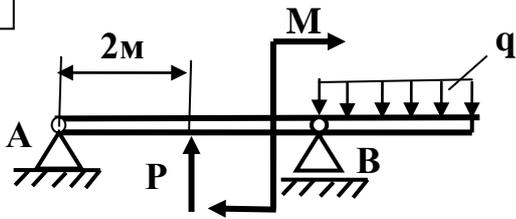
$P = 2 \text{ кН}; q=5\text{кН/м}; M=2 \text{ кН м}$
