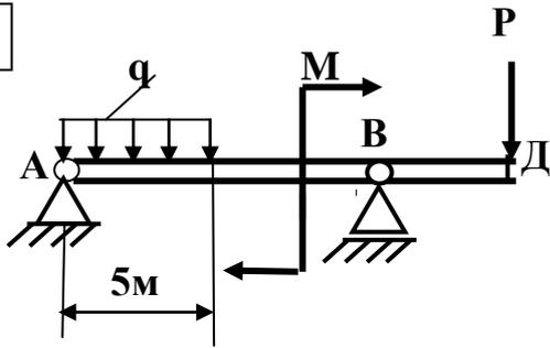
$q = 2 \text{ кН/м}; P=2\text{кН}; M=5 \text{ кН м}$
