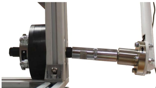
Рисунок 7. Подготовка к испытанию на относительный поворот.
