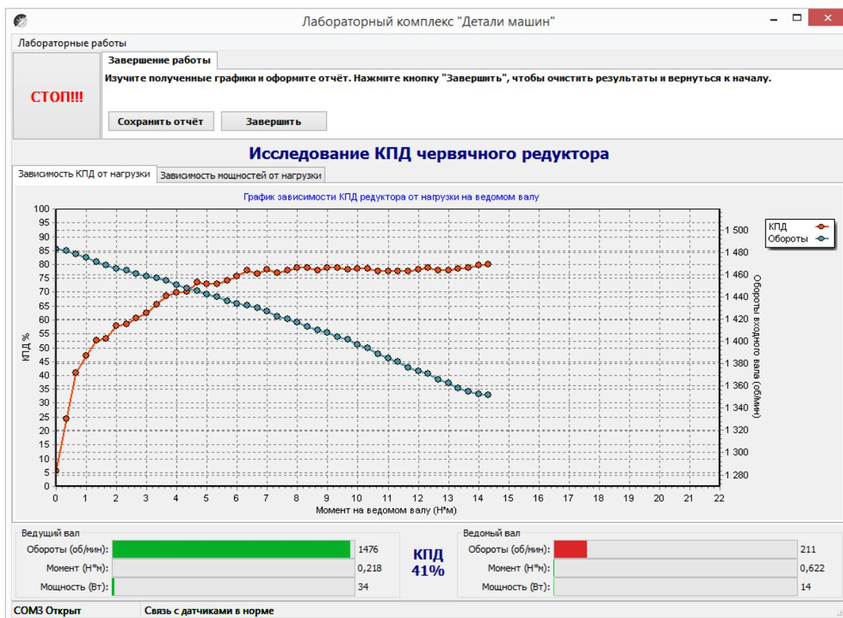
Рисунок 11. Лабораторная работа «Исследование КПД червячного редуктора»
