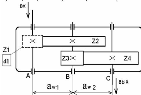
Рисунок 7.6 – Кинематическая схема двухступенчатого цилиндрического редуктора с прямозубой передачей и одним отсутствующим зубчатым колесом
