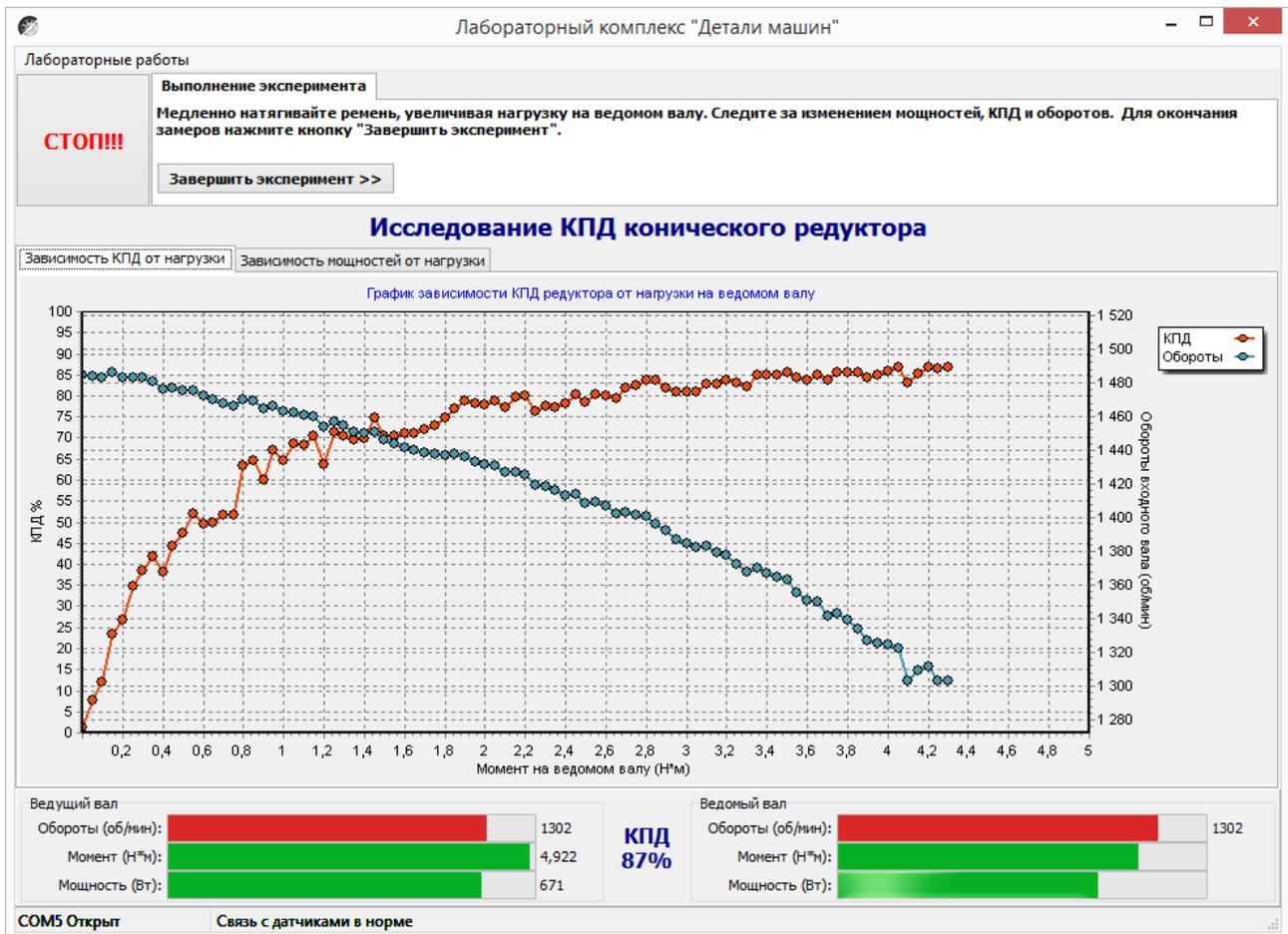
Рисунок 9. Лабораторная работа «Исследование КПД конического редуктора»
