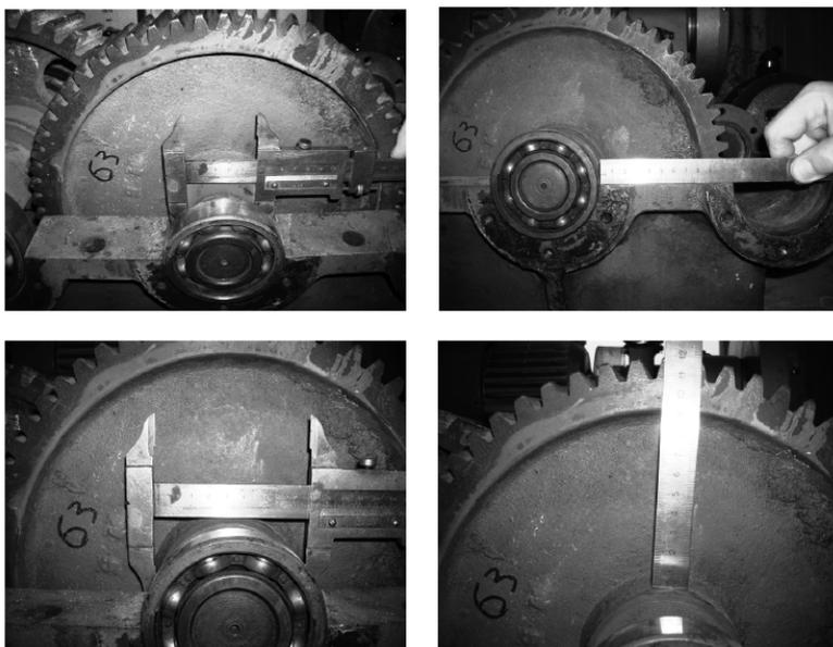
Рисунок 7.1 – Основные приемы измерения штангенциркулем и линейкой
