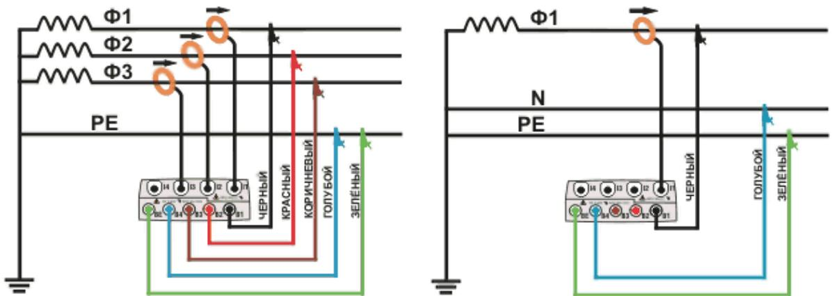
Рисунок 1: Подключение прибора к трёхфазной четырёхпроводной (слева) или однофазной (справа) системе
