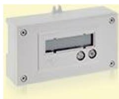
Выносной пользовательский дисплей PLC D выполняет функцию дублирующего дисплея для конкретного счетчика. Это микропроцессорное устройство со встроенным PLC модемом. PLC D принимает информацию только от "своего" счетчика электроэнергии.
