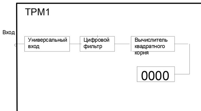
Рис. 3. Структурная схема прибора TPM1
