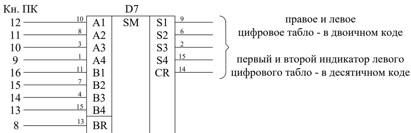
Рисунок 7.4 – Функциональная схема установки для исследования цифрового сумматора
