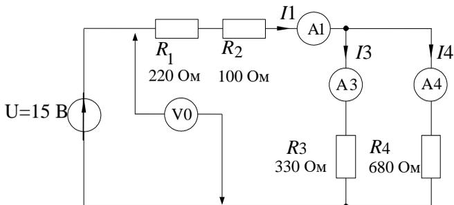
Рисунок 8 – Схема цепи со смешанным соединением резисторов
