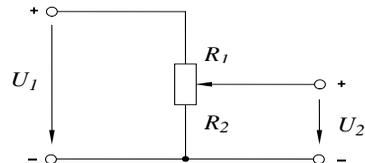
Рисунок 4.2 – Регулируемый делитель напряжения
