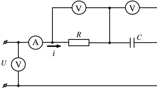
Рисунок 3 – Последовательное соединение резистора и конденсатора
