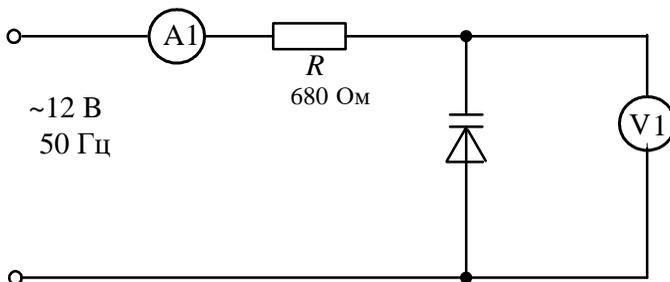
Рисунок 12 – Схема для снятия вольтамперной характеристики варикапа
