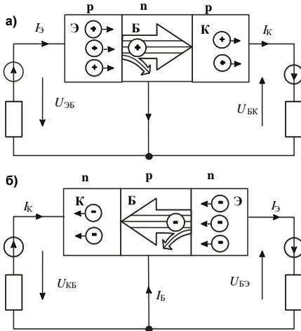
Рисунок 2 – Принцип действия биполярного транзистора *n-p-n* типа
