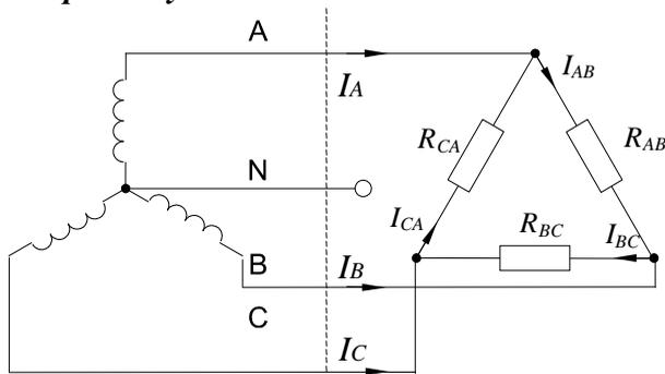
Рисунок 1 – Трехфазная цепь при соединении нагрузки в треугольник
