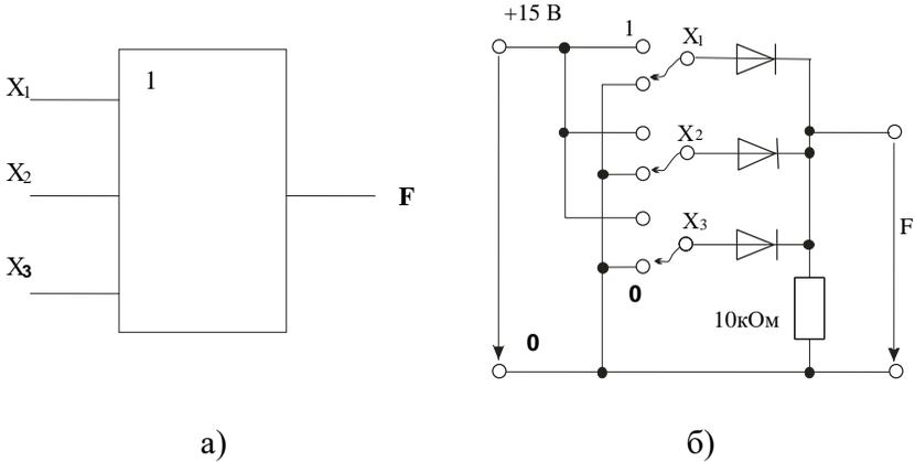
Рисунок 2 – Логический элемент OR с тремя входами
