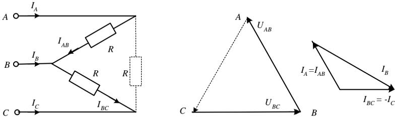
Рисунок 3 – Векторная диаграмма цепи при обрыве фазы нагрузки
