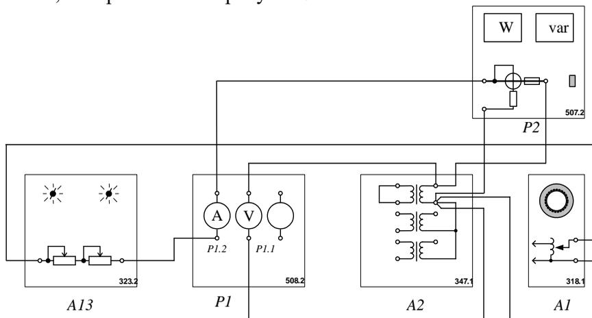
Рисунок 5 – Схема для проведения опыта короткого замыкания трансформатора
