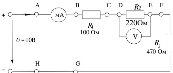
Рисунок 6 – Схема цепи с последовательным соединением резисторов
