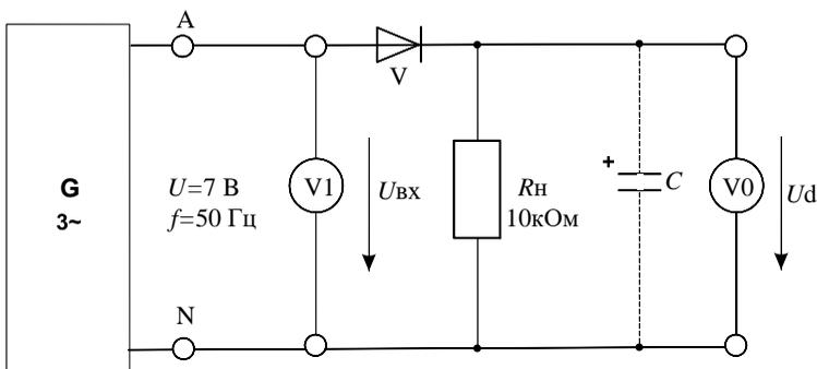
Рисунок 4 – Схема экспериментального исследования однополупериодного выпрямителя
