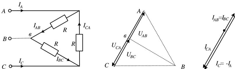
Рисунок 4 – Векторная диаграмма цепи при обрыве линейного провода
