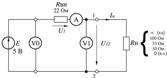
Рисунок 5 – Электрическая схема для исследования реального источника ЭДС
