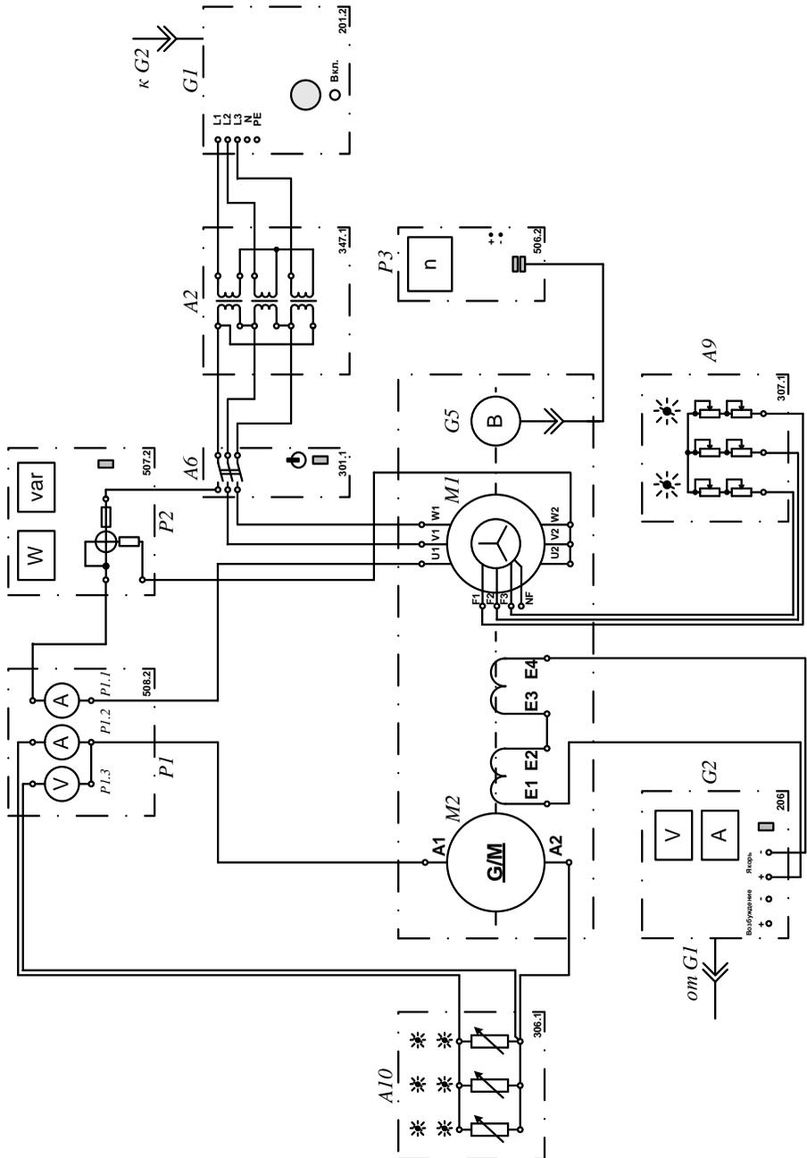
Рисунок 2 – Схема для снятия рабочих характеристик
