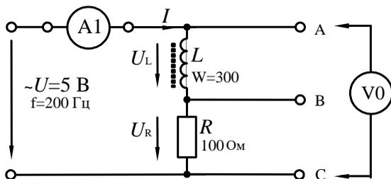
Рисунок 7 – Схема экспериментального исследования неразветвленной цепи  $RL$
