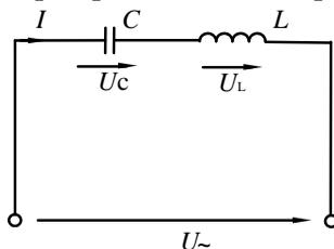
Рисунок 5 – Цепь с последовательным соединением катушки и конденсатора
