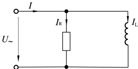
Рисунок 1 – Цепь с параллельным соединением резистора и катушки
