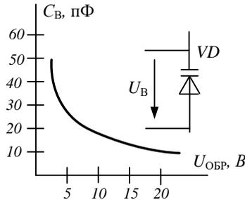
Рисунок 2 – Зависимость емкости варикапа от обратного напряжения
