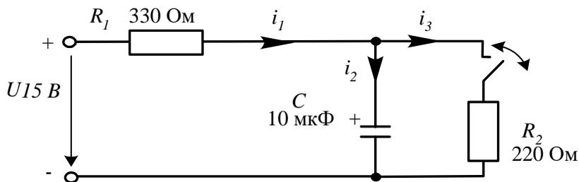
Рисунок 1 – Расчетная схема для аналитического исследования цепи  $RC$
