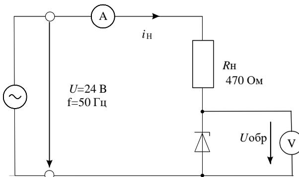
Рисунок 5 – Схема для получения вольтамперной характеристики стабилитрона
