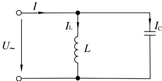
Рисунок 5 – Цепь с параллельным соединением катушки и конденсатора
