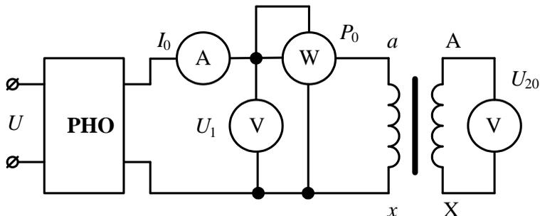
Рисунок 2 – Схема опыта холостого хода трансформатора
