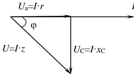
Рисунок 4 – Векторная диаграмма последовательного соединения R и C
