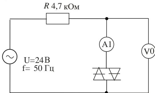
Рисунок 6 – Схема для снятия динамической характеристики симистора
