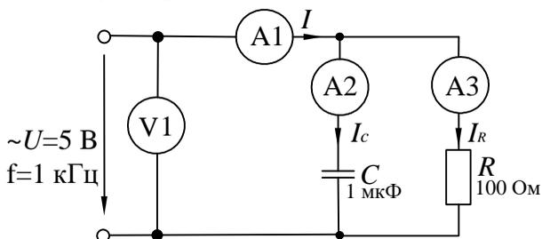
Рисунок 10 – Схема экспериментального исследования разветвленной цепи RC
