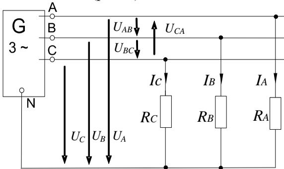
Рисунок 6 – Исследование работы цепи при симметричной нагрузке
