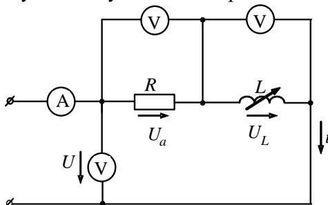
Рисунок 1 – Последовательное соединенипе резистора и индуктивной катушки
