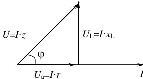
Рисунок 2 – Векторная диаграмма последовательного соединения  $R$  и  $L$
