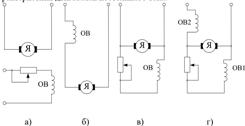
Рисунок 1 – Способы возбуждения машины постоянного тока
