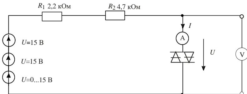
Рисунок 4 – Схема для снятия статической характеристики симистора
