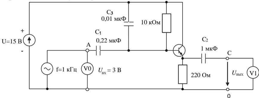
Рисунок 3 – Схема усилителя с общим коллектором
