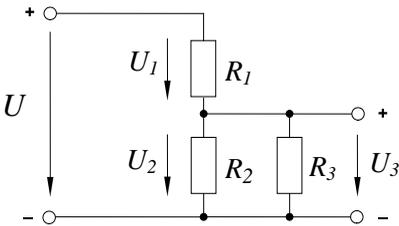
Рисунок 5.1 – нерегулируемый делитель напряжения с подключенной нагрузкой
