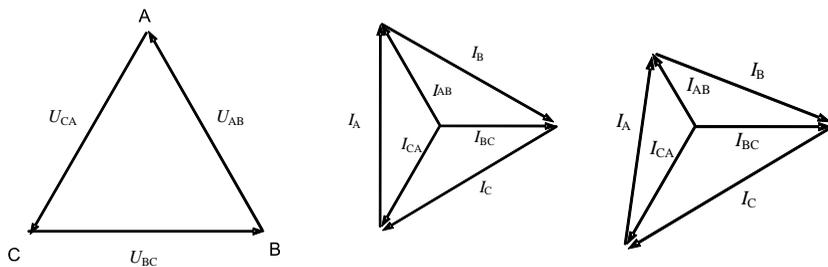
а) симметричная нагрузка б) несимметричная нагрузка
