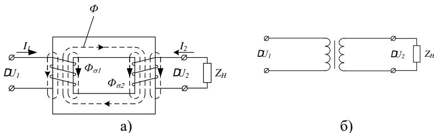
Рисунок 1 – Устройство и условное обозначение однофазного трансформатора
