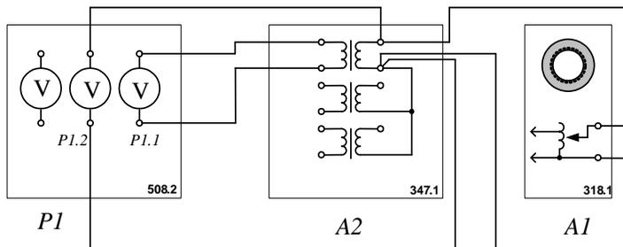
Рисунок 3 – Схема установки для определения коэффициента трансформации
