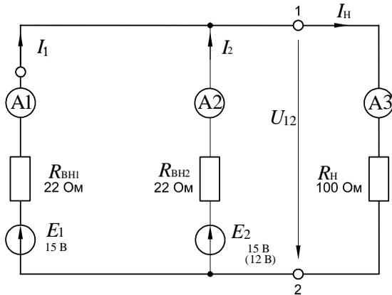
Рисунок 8 – Схема для исследования параллельного включения источников ЭДС
