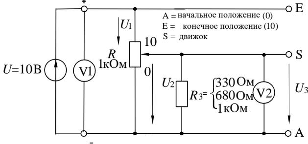
Рисунок 11 – Схема делителя напряжения под нагрузкой
