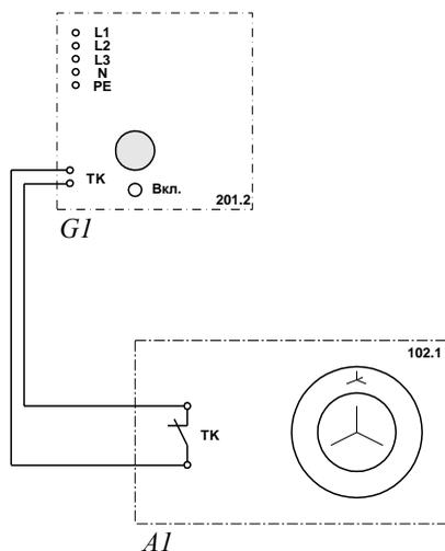
Рисунок 5 – Электрическая схема тепловой защиты машины переменного тока
