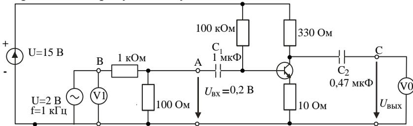
Рисунок 1 – Схема усилителя с общим эмиттером
