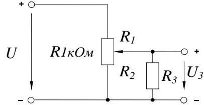
Рисунок 5.2 – Регулируемый делитель напряжения с подключенной нагрузкой
