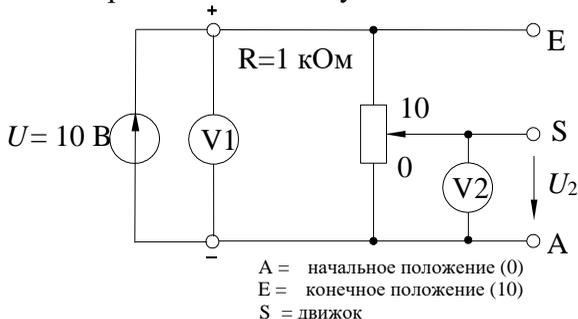
Рисунок 9 – Схема делителя напряжения в режиме холостого хода
