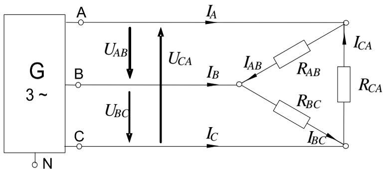
Рисунок 7 – Исследование цепи при симметричной активной нагрузке
