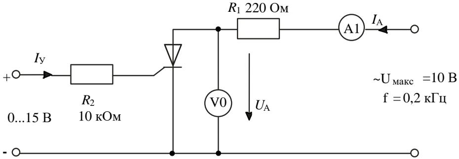
Рисунок 10 – Схема для снятия вольтамперной характеристики тиристора
