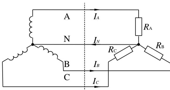
Рисунок 1 – Трехфазная цепь при включении нагрузки в звезду
