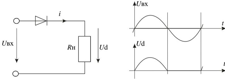
Рисунок 2 – Схема и временные диаграммы однополупериодного выпрямителя
