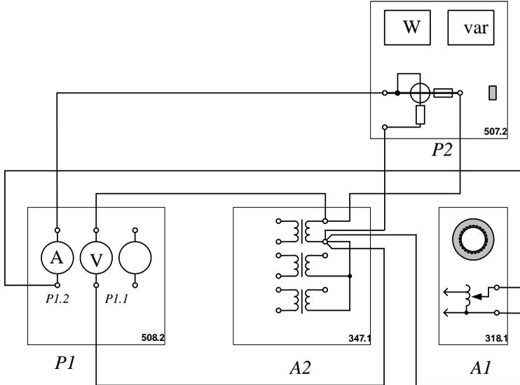
Рисунок 4 – Схема для проведения опыта холостого хода трансформатора
