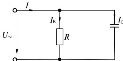
Рисунок 3 – Цепь с параллельным соединением резистора и конденсатора
