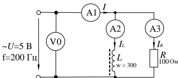
Рисунок 7 – Схема экспериментального исследования разветвленной цепи  $RL$
