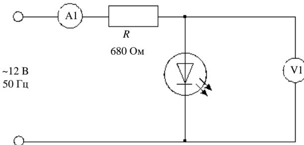
Рисунок 9 – Схема для снятия вольтамперной характеристики светодиода
