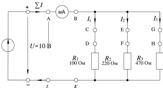
Рисунок 7 – Схема цепи с параллельным соединением резисторов
