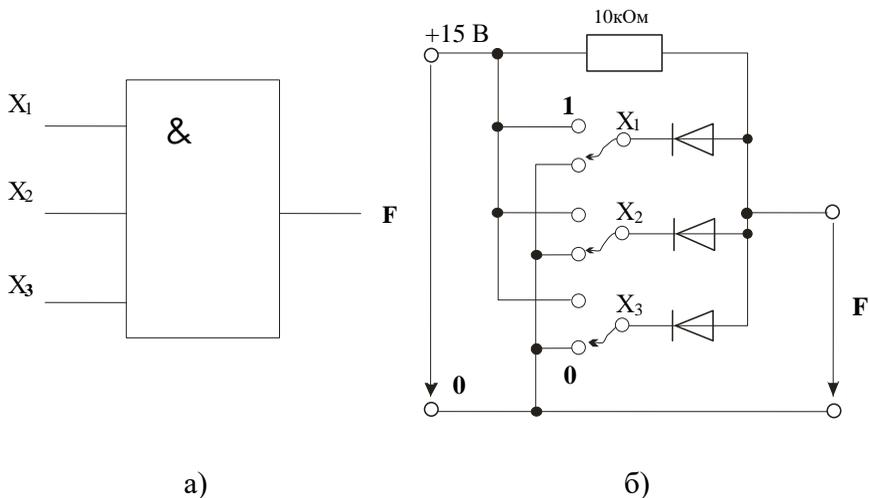
Рисунок 1 – Логический элемент AND с тремя входами
