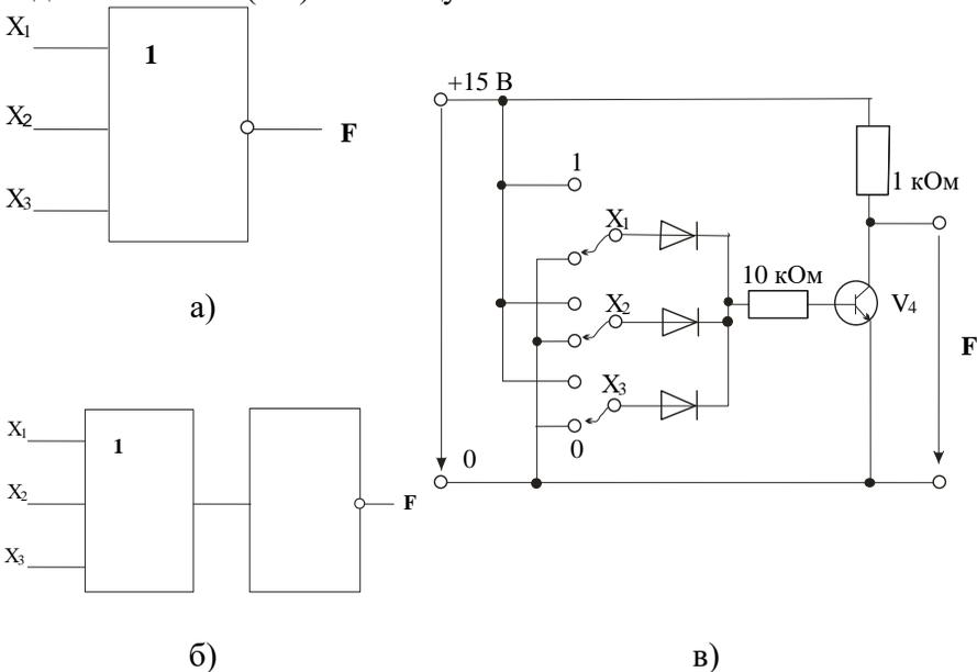
Рисунок 5 – Логический элемент NOT – OR
