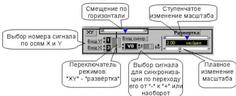
Рисунок 6 – Органы управления горизонтальным положением луча
