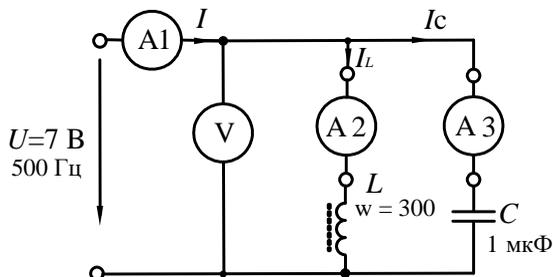
Рисунок 13 – Схема экспериментального исследования разветвленной цепи LC
