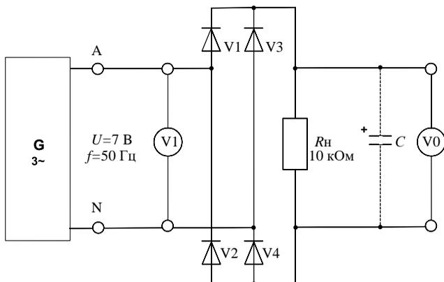
Рисунок 6 – Схема экспериментального исследования двухполупериодного мостового выпрямителя
