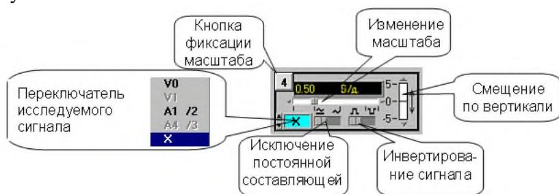
Рисунок 5 – Блок входов и вертикального отклонения
