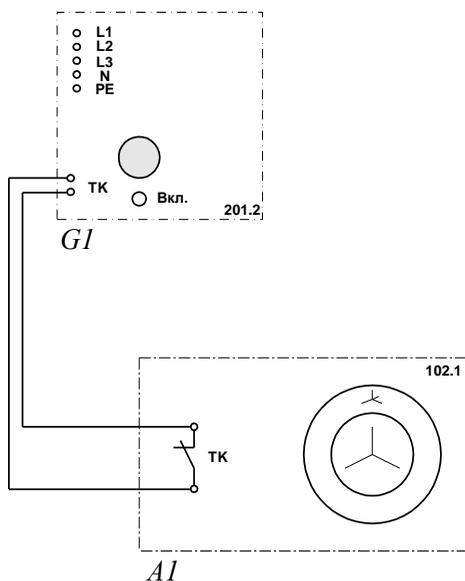
Рисунок 3 – Схема тепловой защиты машины переменного тока
