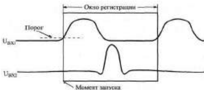
Рис. 8.9. Послепусковая регистрация в аналоговых осциллографах
