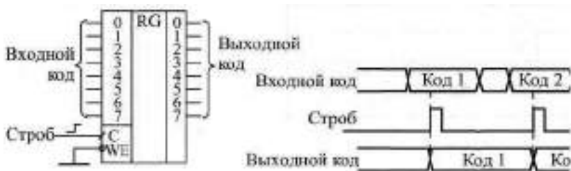
Рис. 4.20. Хранение кода в параллельном регистре
