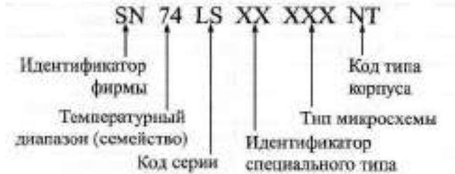
Рис. 1.17. Система обозначений фирмы Texas Instruments
