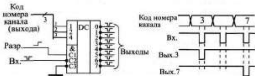
Рис. 3.5. Включение дешифратора как демультиплексора
