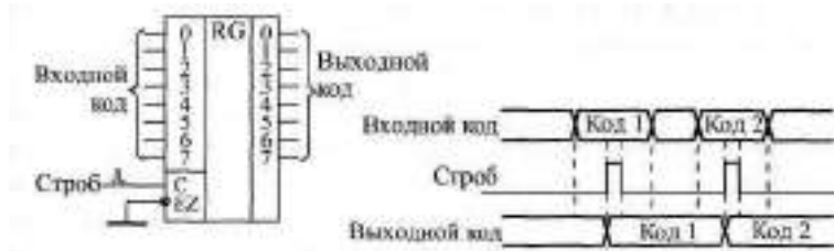
Рис. 4.29. Использование регистра-зашелки для замены регистра, срабатывающего по фронту
