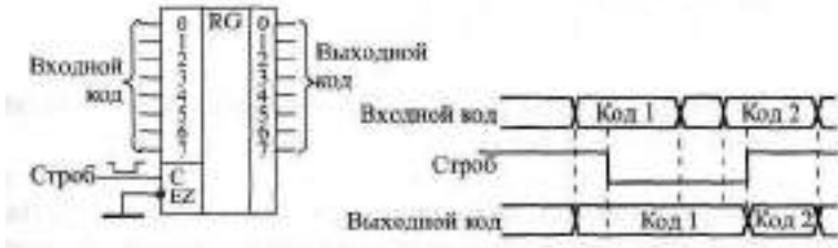
Рис. 4.28. Продление длительности входного кода с помощью регистра-зашелки
