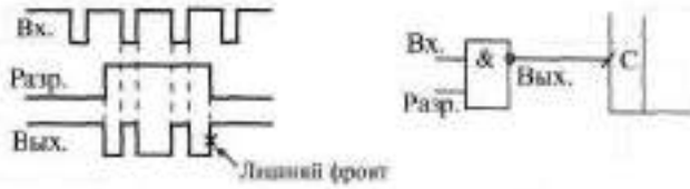
Рис. 2.18. Появление лишнего фронта при запрещении входного сигнала
