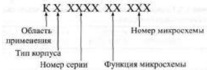
Рис. 1.18. Обозначения отечественных микросхем
