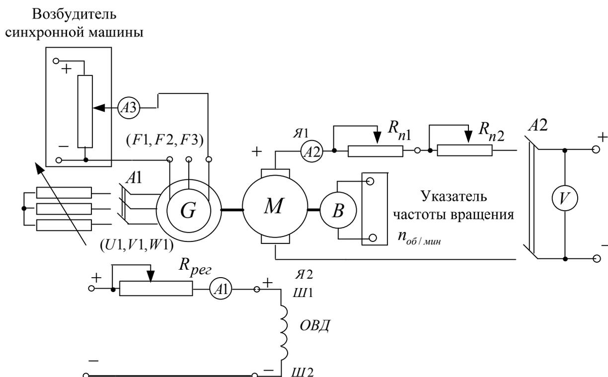
Рисунок 2.4.1 Принципиальная электрическая схема для снятия пусковых характеристик двигателя постоянного тока с независимым возбуждением. G- синхронный генератор; М- машина постоянного тока (двигатель); Я1-Я2- концы якорной обмотки; Ш1-Ш2- концы шунтовой (параллельной) обмотки возбуждения;  $R_n$ - нагрузочный реостат;  $R_{рег}$  - регулировочный реостат;  $R_{n1}$ ,  $R_{n2}$  - пусковые реостаты
