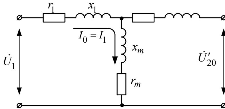
Рисунок 4.1.2 Схема замещения трансформатора в режиме холостого хода
