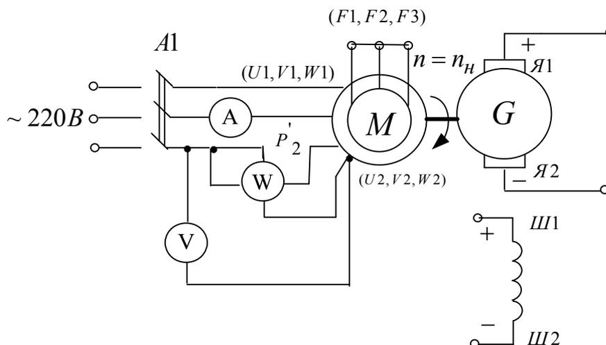
Рисунок 3.2.1 Принципиальная электрическая схема для проведения опыта холостого хода
