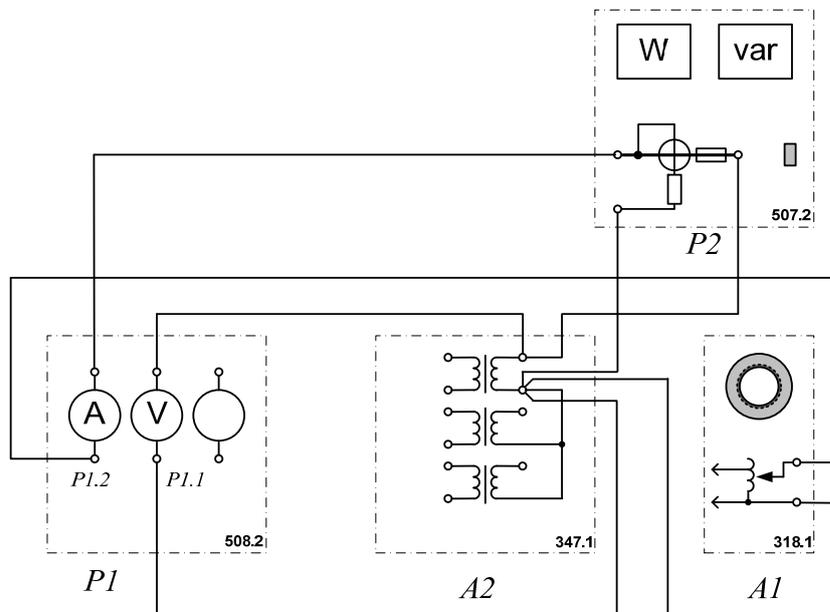
Рисунок 4.1.4 – Электрическая схема соединений для снятия характеристик холостого хода.
