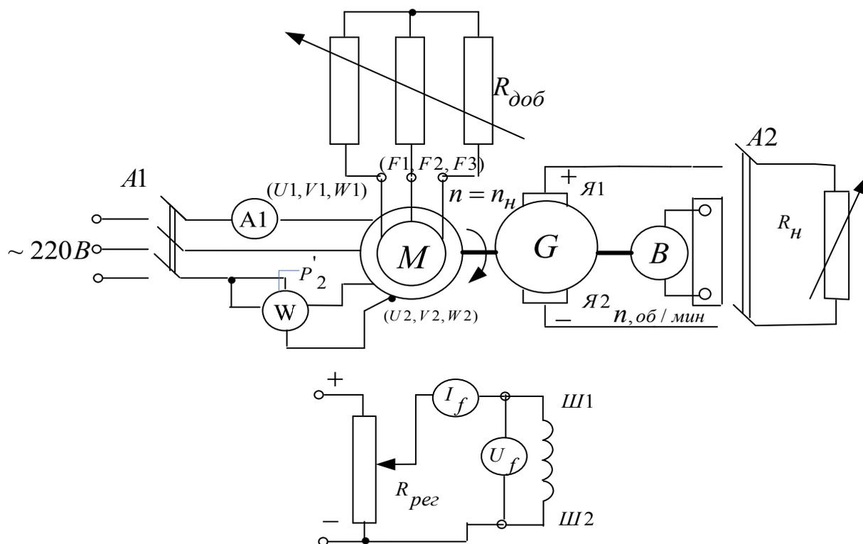
Рисунок 3.3.2 Принципиальная электрическая схема для определения механической характеристики  $n=f(M)$  (фазный ротор):  $R_{доб}$  - добавочное сопротивление в цепи фазного ротора асинхронного двигателя.
