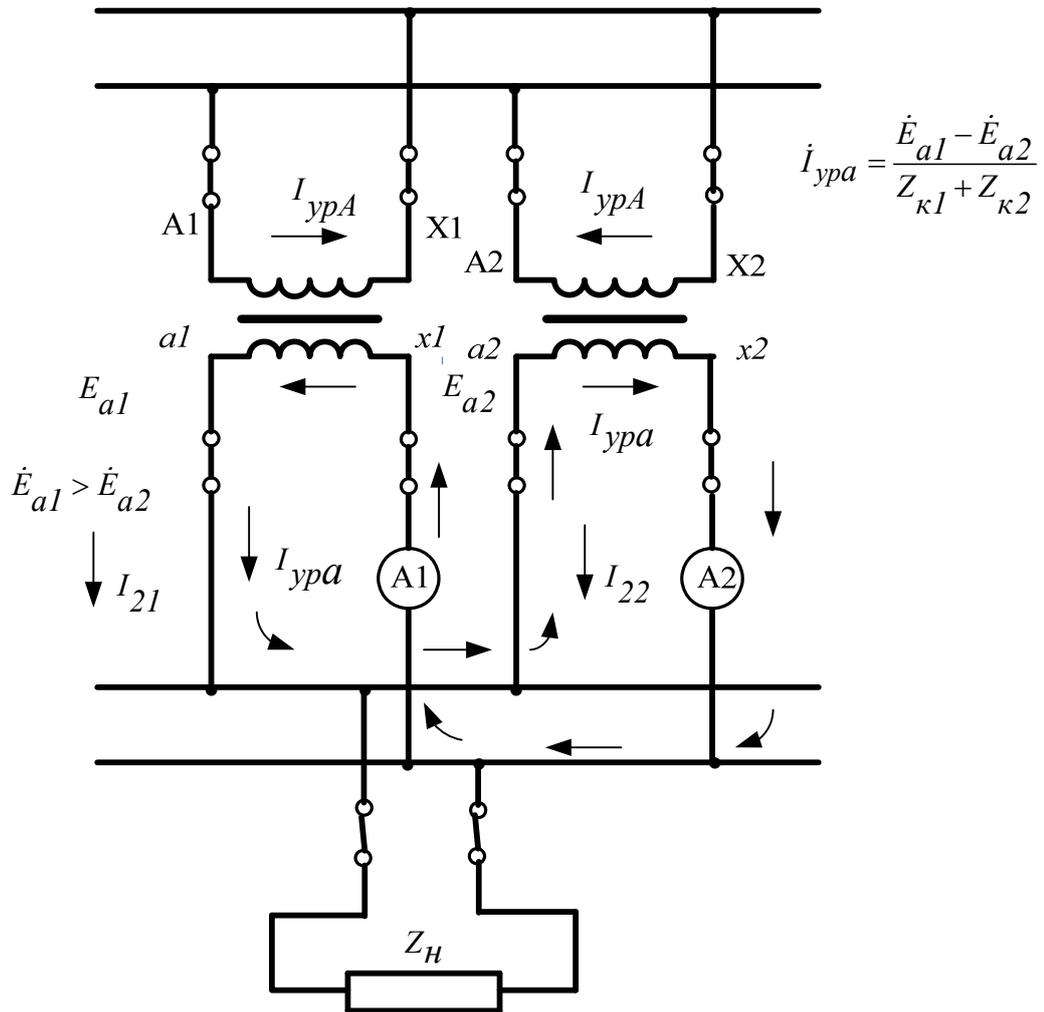
Рисунок 4.2.6 Параллельная работа трансформаторов при несоблюдении первого условия (неравенство коэффициентов трансформации) при нагрузке.
