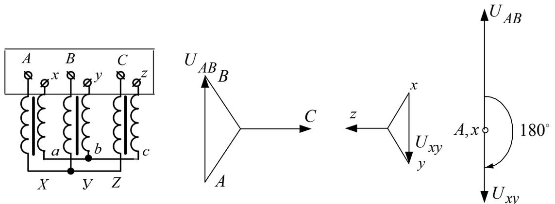
Рисунок 4.2.2 Схема соединения обмоток трансформатора и векторные диаграммы для группы Y/Y-6.
