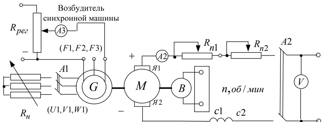
Рисунок 2. 4.3 Принципиальная электрическая схема для снятия пусковых характеристик двигателя постоянного тока с последовательным возбуждением. G- синхронный генератор; М- машина постоянного тока (двигатель); Я1-Я2- концы якорной обмотки; Ш1-Ш2- концы шунтовой (параллельной) обмотки возбуждения; R<sub>н</sub>- нагрузочный реостат; R<sub>рег</sub> - регулировочный реостат; R<sub>н1</sub>, R<sub>н2</sub> - пусковые реостаты
