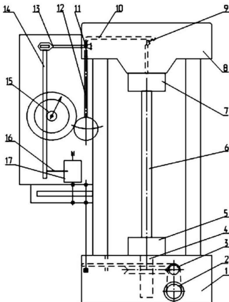
Рисунок 19 – Машина для испытания на кручение КМ-50-1
