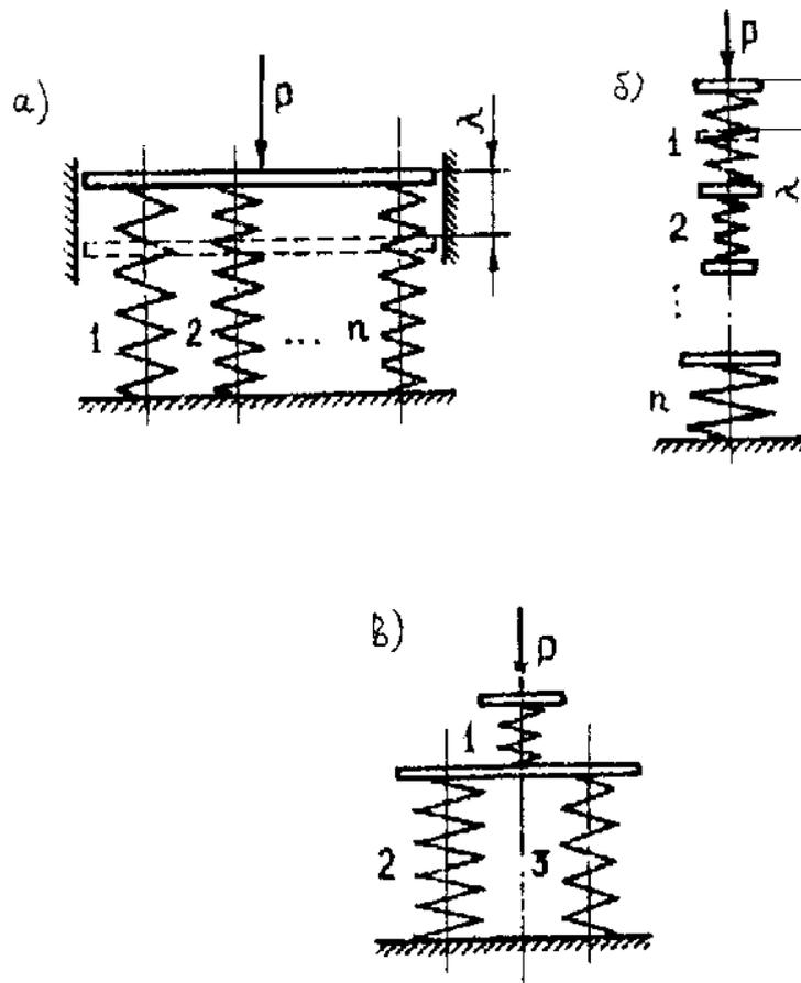
Рисунок 21 – Системы пружин
