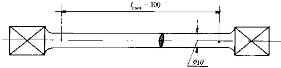
Рисунок 18 – Образец для испытания на кручение
