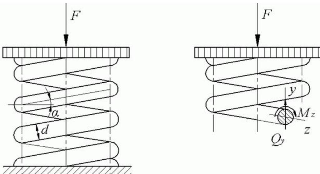
Рисунок 22 – Сечение пружины
