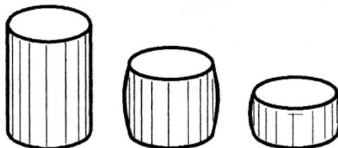
Рисунок 9 – Цилиндрическая форма образца переходит в бочкообразную
