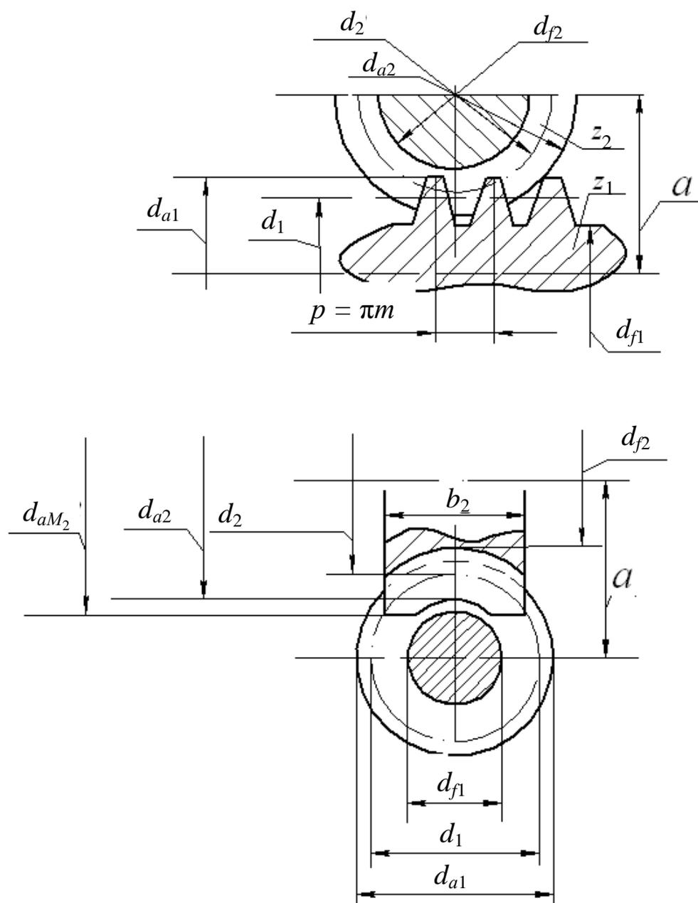
Рисунок 32 – Параметры передачи, червяка и червячного колеса
