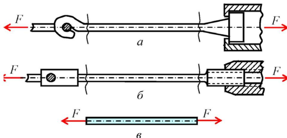
Рисунок 1 – Способы передачи усилий к стержню
