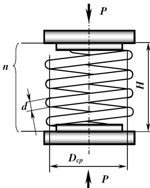
Рисунок 20 – Расчетная схема витой цилиндрической пружины
