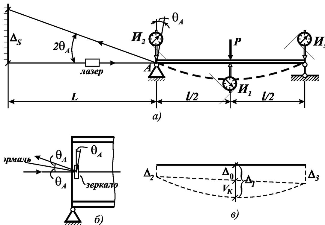
Рисунок 27 – Схема испытательной установки с измерительными приборами
