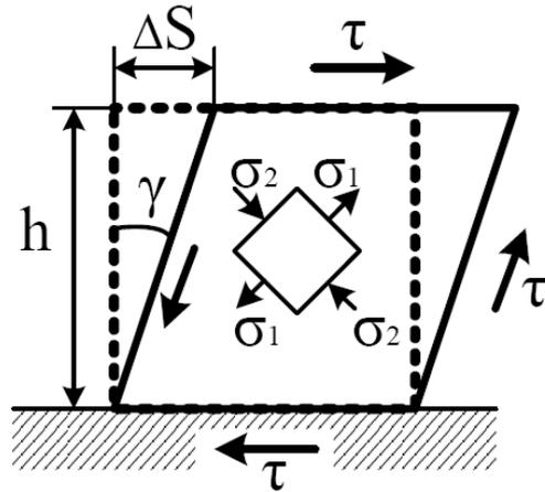
Рисунок 15 – Напряженное состояние при чистом сдвиге
