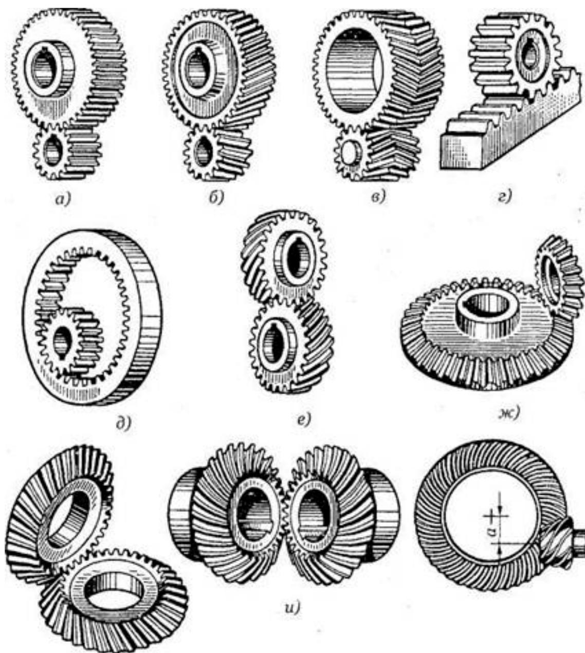
а, б, в – цилиндрические зубчатые передачи с внешним зацеплением;
