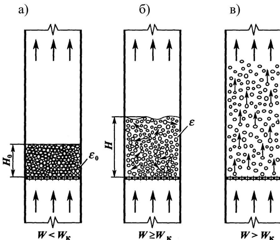
Рисунок 1 Схемы состояний слоя зернового материала:
