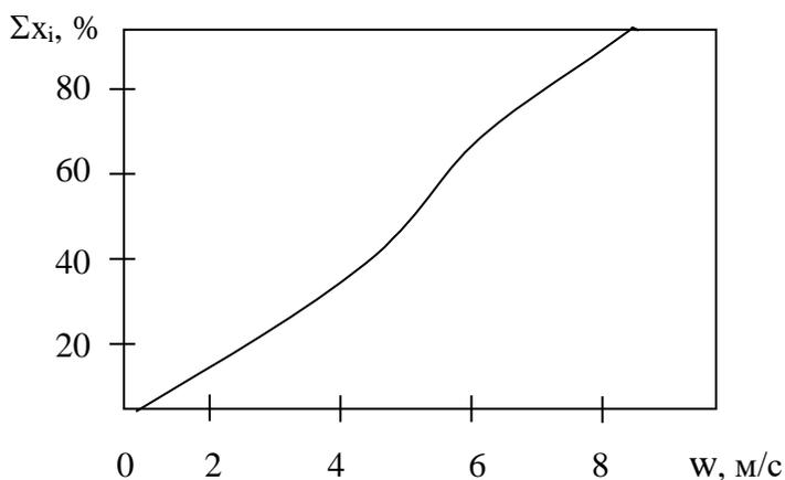
Рис. 2. Интегральная кривая распределения частиц по скорости витания.
