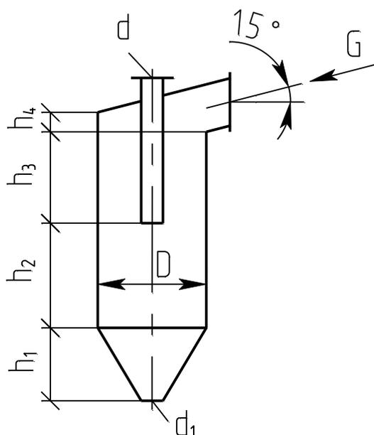
Рисунок 2.7 – Схема к расчету циклона (обозначения в тексте)
