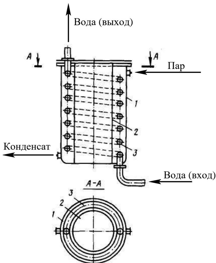
Рисунок 3.1 - Схема змеевикового теплообменника к задаче 3.1:
