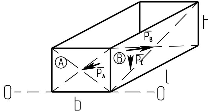
Рисунок 1.1 – Схема к задаче 1.1:  $\overline{P_A}, \overline{P_B}, \overline{P_C}$  – силы давления;  $b \times l \times h$  – размеры сосуда; 0 – 0 – плоскость сравнения
