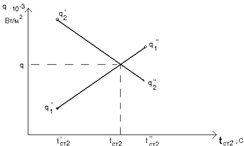
Рисунок 2 - Определение истинного значения температуры стенки
