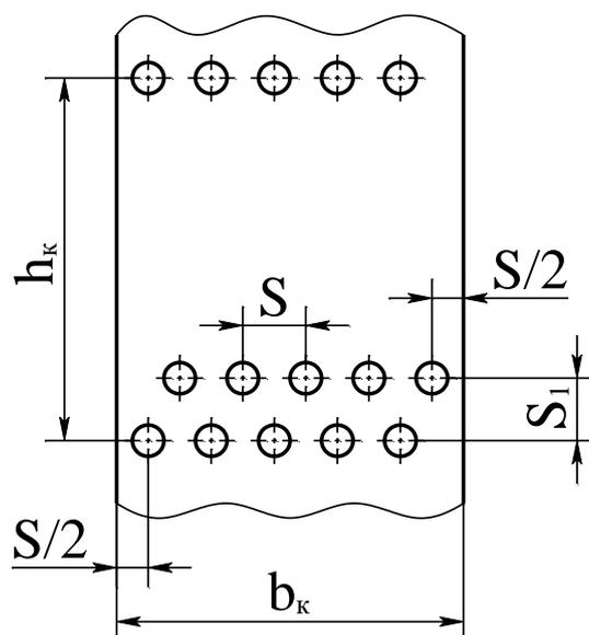
Рисунок 3.4 – Схема к определению размеров камеры конвекции
