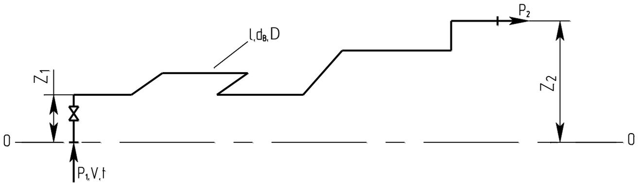
Рисунок 2.2 – Схема к расчету: 0–0 – плоскость сравнения
