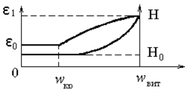
Рисунок 5 Расширение и пределы существования кипящего слоя.
