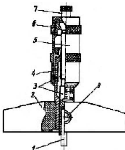
Рис. 5.3. Микрометрический глубиномер
