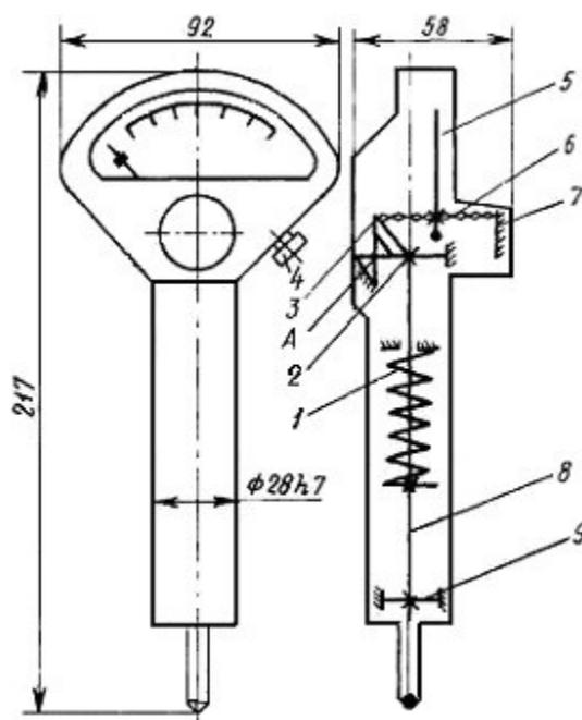
Рисунок 7.1. Схема микрокатора
