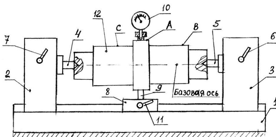
Рис. 8.1. Приспособление для измерения биения
