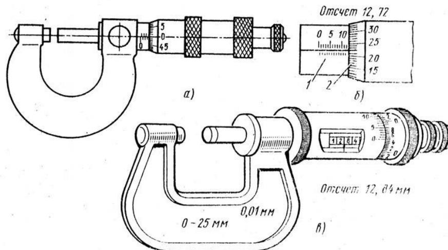
**Рис. 5.1.** Микрометр гладкий (а) и примеры отсчета (б и в)
