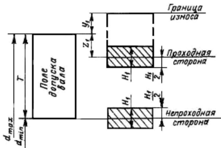
Рис. 2.4. Схема расположения полей допусков калибров для валов
