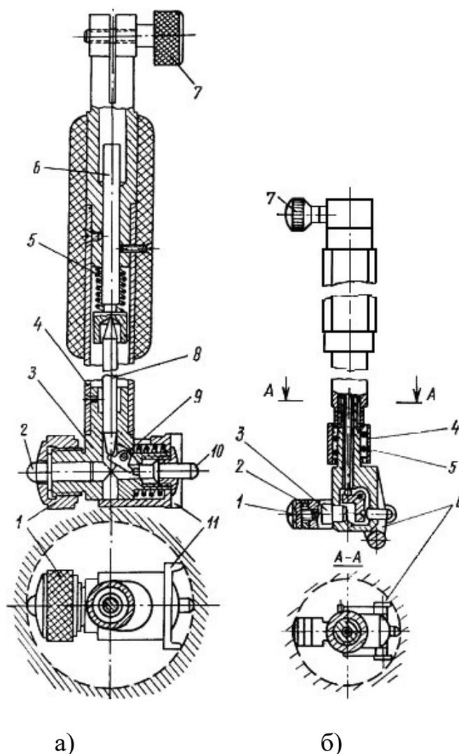
**Рис. 6.3.** Устройство индикаторного нутромера
