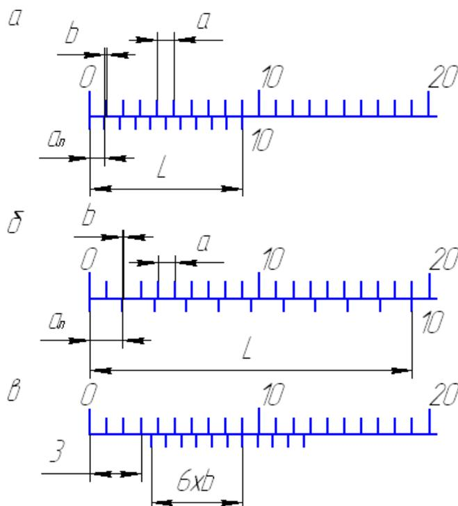
**Рис. 4.4.** Схема нониусного устройства
