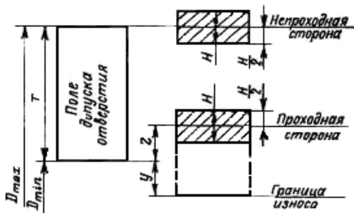
Рис. 2.3. Схема расположения полей допусков калибров для отверстий
