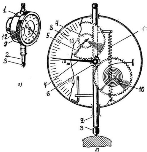
**Рис. 6.1.** Индикатор часового типа:
