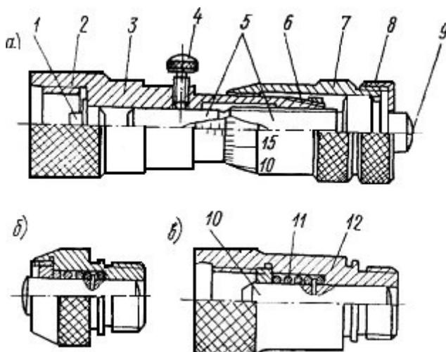
Рис. 5.2. Микрометрический нутромер
