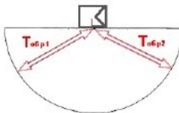
Рисунок 6.6 - Путь УЗ луча в образце СО-3
