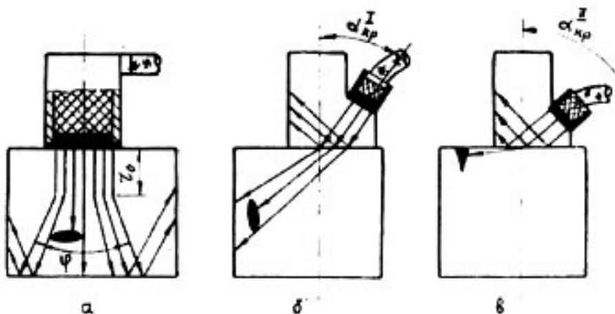
Рисунок 6.1 Схема получения и распространения ультразвуковых волн:
