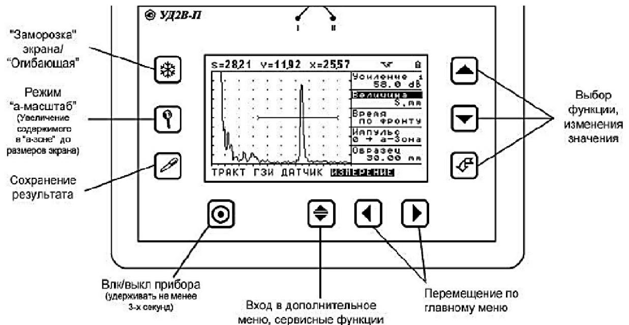
Рисунок 6.4 – Передняя панель дефектоскопа УД2В-П45 Lite
