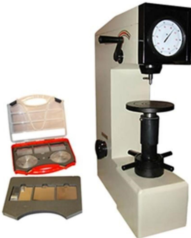
Рисунок 4.3 – Общий вид лабораторной установки для определения твердости по методу Роквелла.
