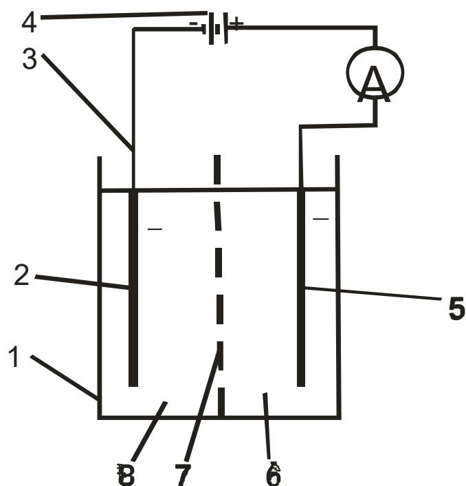
Рисунок 7.1 – Электролизная ванна: 1 – корпус ванны; 2 – катод;
