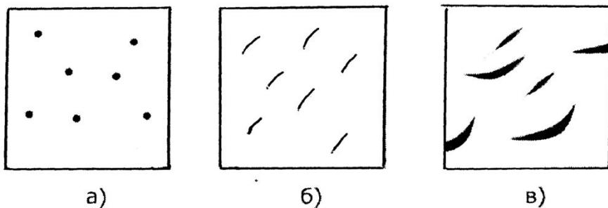
Рисунок 3.1 – Неметаллические включения в стали и в чугуне:
