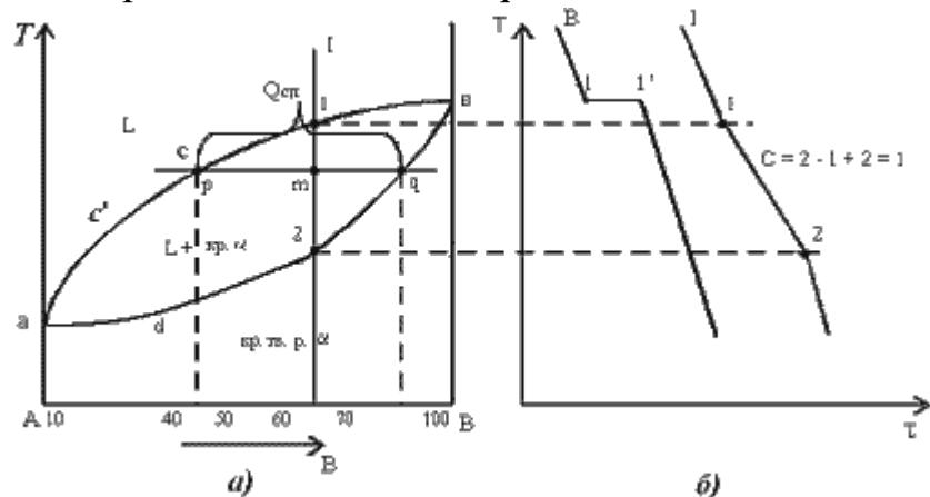
Рис.2. Диаграмма состояния сплавов с неограниченной растворимостью компонентов в твердом состоянии (а); кривые охлаждения типичных сплавов (б) Анализ полученной диаграммы (рис.2).
