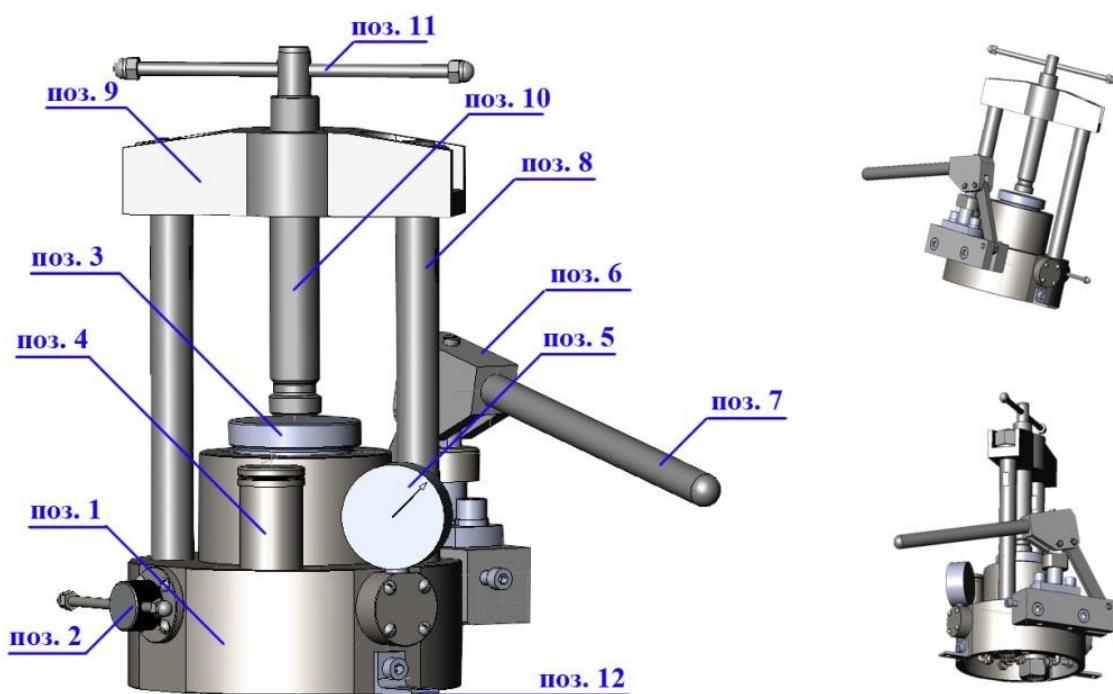
Рисунок 5.6 – Устройство пресса: 1 – корпус; 2 – выпускной винт; 3 – пятка; 4 – бак; 5 – манометр; 6 – ручной насос; 7 – ручка насоса; 8 – колонны; 9 – перекладина; 10 – прижимной винт; 11 – ручка винта; 12 – кронштейн.
