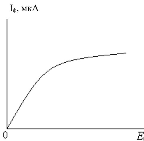
Рисунок 24.4 – Световая характеристика  $\Phi C$
