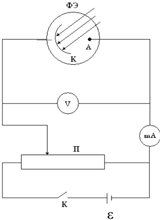
Рисунок 25.1 – Схема включения фотоэлемента в цепь
