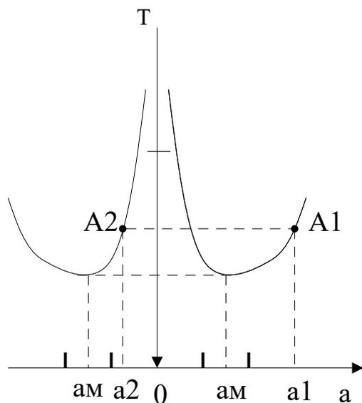
Рисунок 6.2 – Схема определения приведенной длины физического маятника
