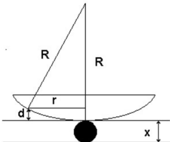
Рисунок 20.3 – Линза на пластине с учетом зазора
