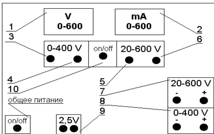
Рисунок. 18.5 – Передняя панель источника питания УИП –1
