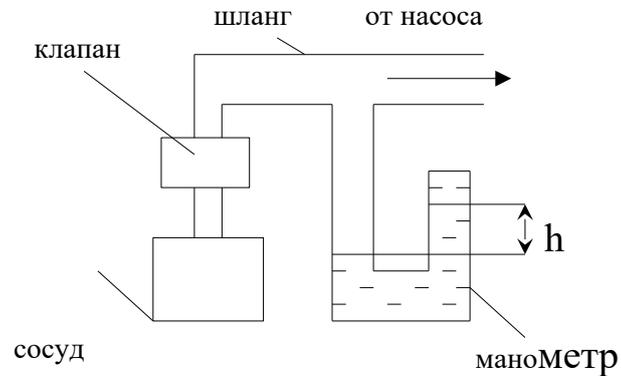
Рисунок 8.2 – Схема экспериментальной установки
