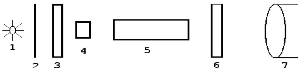
Рисунок 22.5 – Принципиальная схема поляриметра
