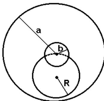
Рисунок 18.4 – Схема определения радиуса кривизны траектории электрона
