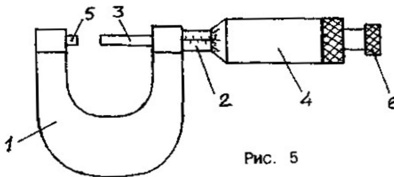
Рисунок 2.5 – Микрометр для наружных измерений
