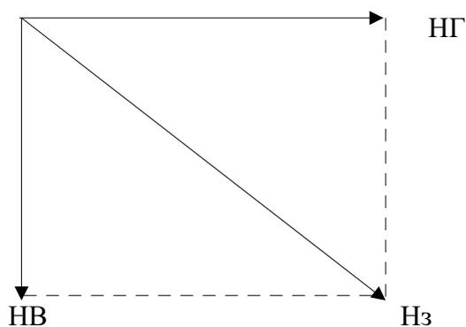
Рисунок 16.1 – Разложение вектора напряженности магнитного поля Земли
