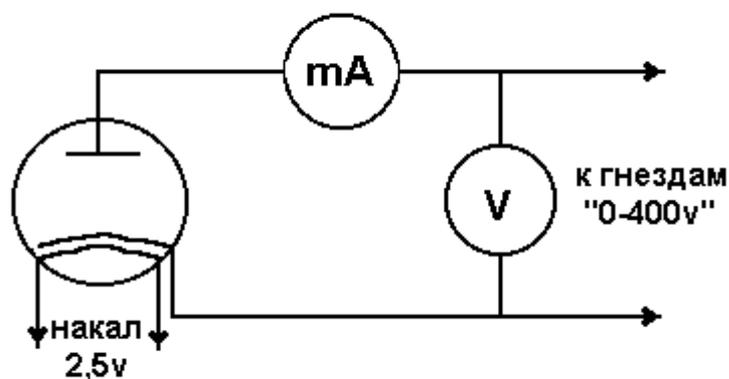
Рисунок 18.7 – Схема цепи накала и анодной цепи
