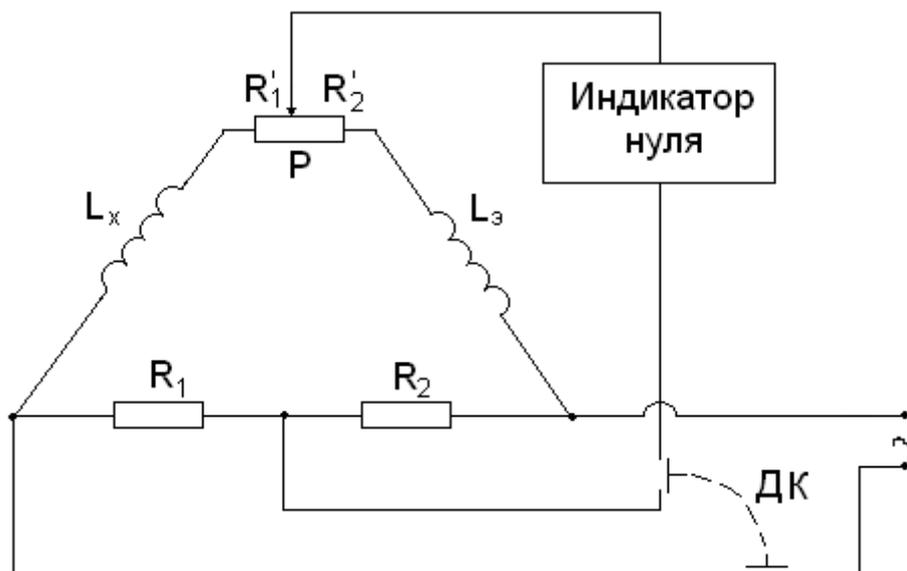
Рисунок 14.2 – Электрическая схема установки
