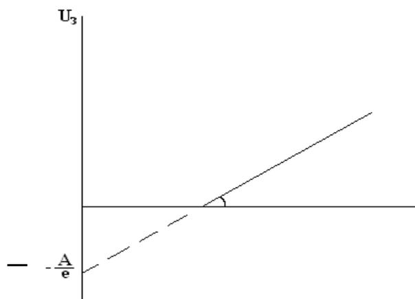
Рисунок 25.3 – Зависимость задерживающего потенциала от частоты света
