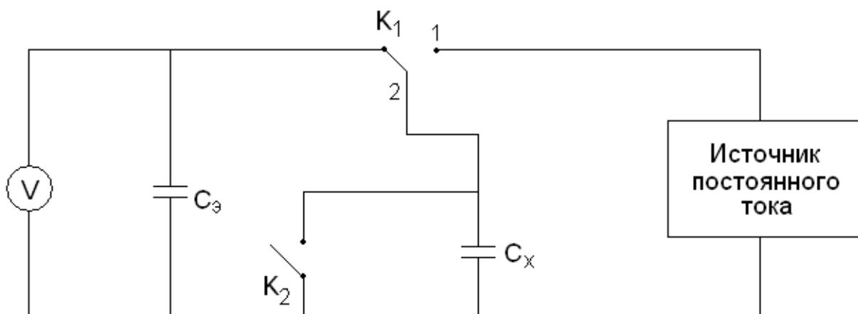
Рисунок 13.1 – Схема измерения емкости конденсатора методом электростатического вольтметра
