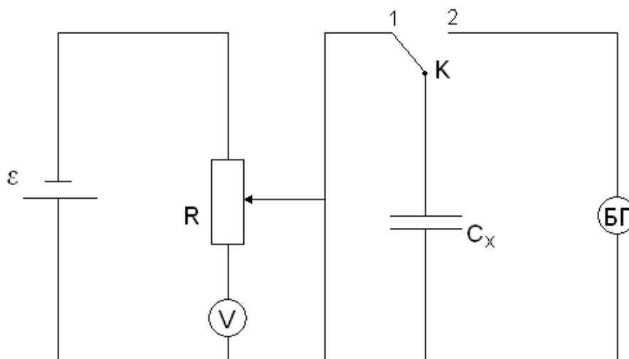
Рисунок 13.2 – Схема измерения емкости конденсатора методом баллистического гальванометра
