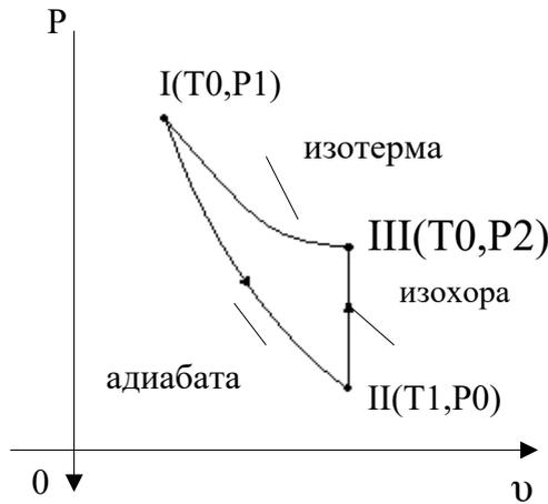
Рисунок 8.1 – Схема проведения опыта
