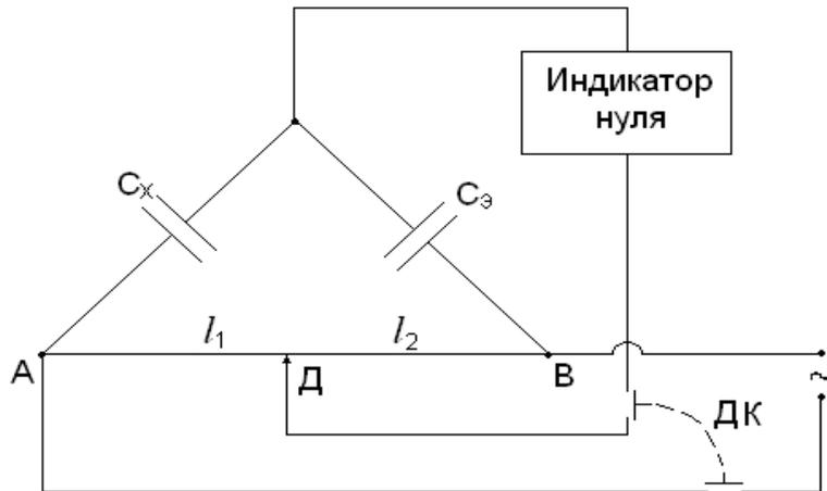
Рисунок 13.4 – Электрическая схема установки моста переменного тока.
