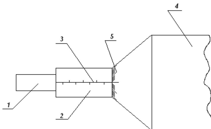
Рисунок 2.4 – Микрометрический винт
