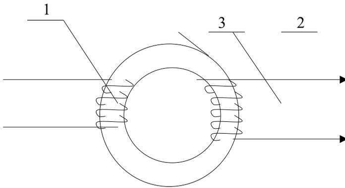
Рисунок 17.1 – Схема трансформатора
