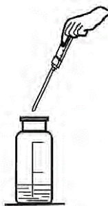
Рисунок 9. Соединение шприца-дозатора с пипеткой для титрования
