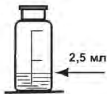
Рисунок 8. Мерная склянка, заполненная анализируемой водой
