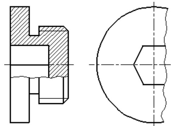
Рисунок 2.15 – Совмещение на изображении части вида и разреза.
