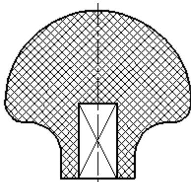
Рисунок 2.42 – Выделение на чертеже плоских поверхностей
