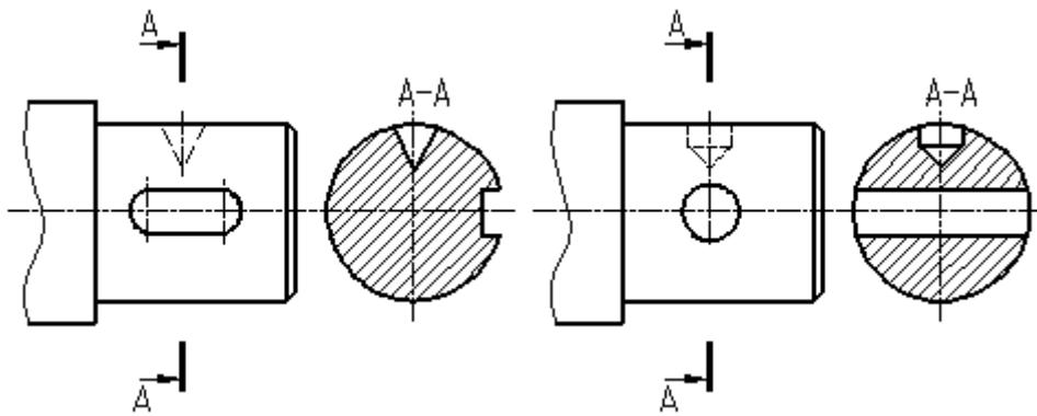
Рисунок 2.28 – Оформление сечения, проходящего через ось поверхности вращения.
