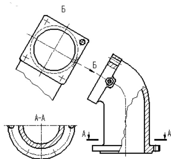
Рисунок 2.4 – Расположение и обозначение дополнительного вида.
