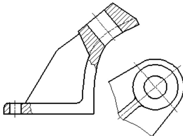
Рисунок 2.5 – Дополнительный вид (без нарушения проекционной связи).
