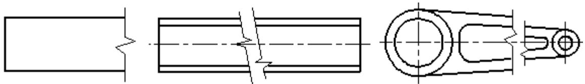
Рисунок 2.43 – Образцы изображения предметов, имеющих постоянное или закономерно изменяющееся сечение.
