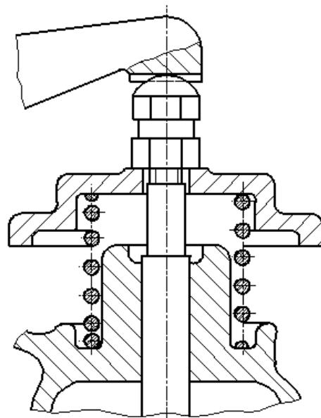
Рисунок 2. Пример изображения винтовой пружины на сборочном чертеже
