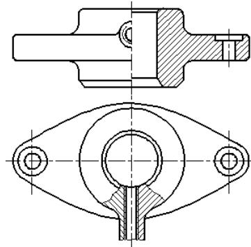
Рисунок 2.17 – Совмещение на изображении части вида и разреза.
