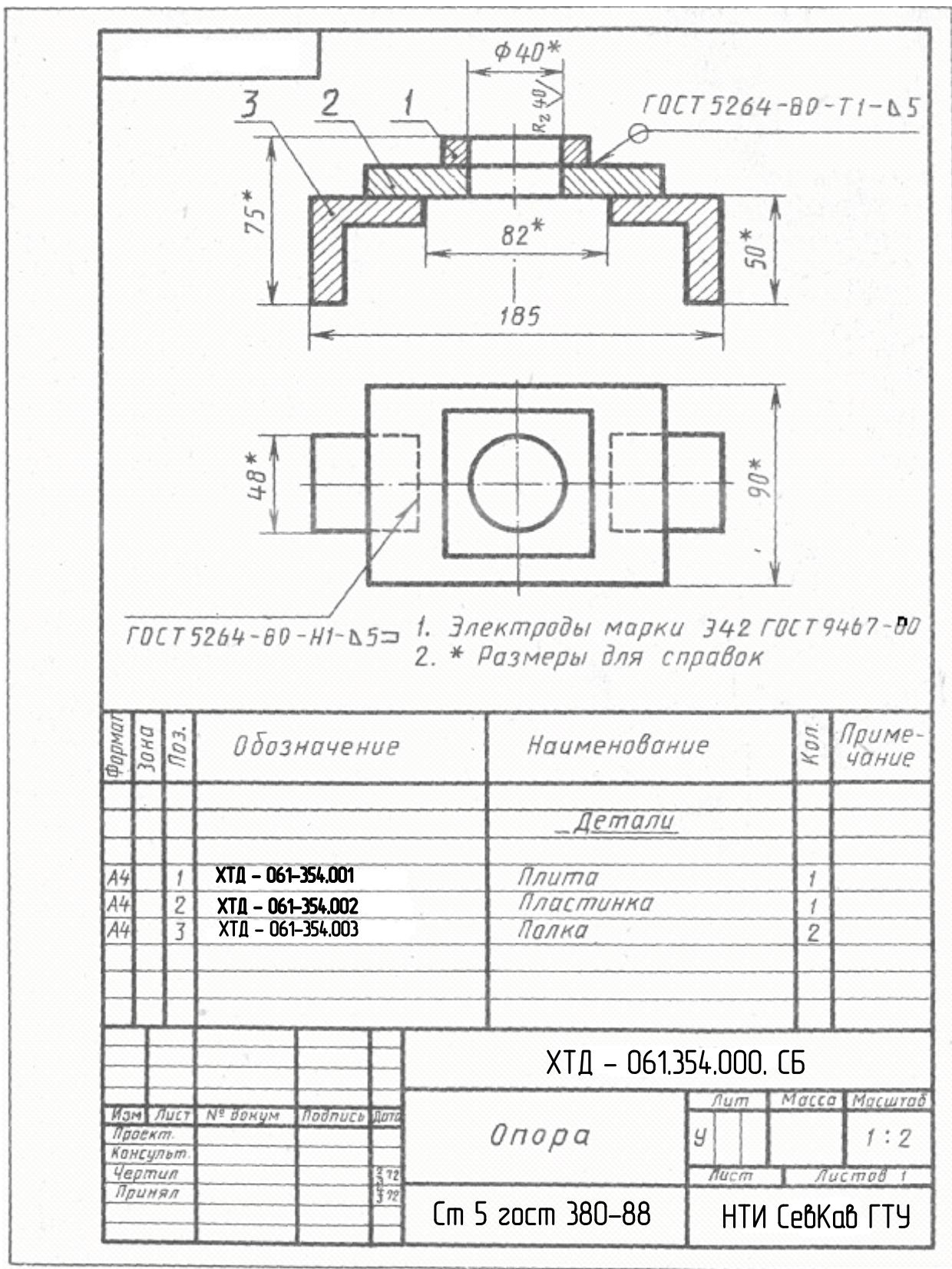
Рисунок 3.52 – Пример выполнения чертежа сварной детали
