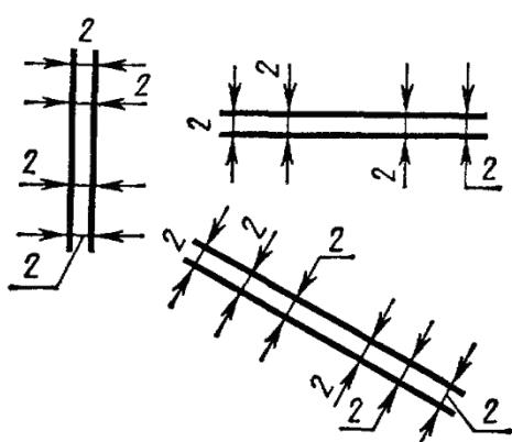
Рисунок 4.11 - Нанесение размерного числа
