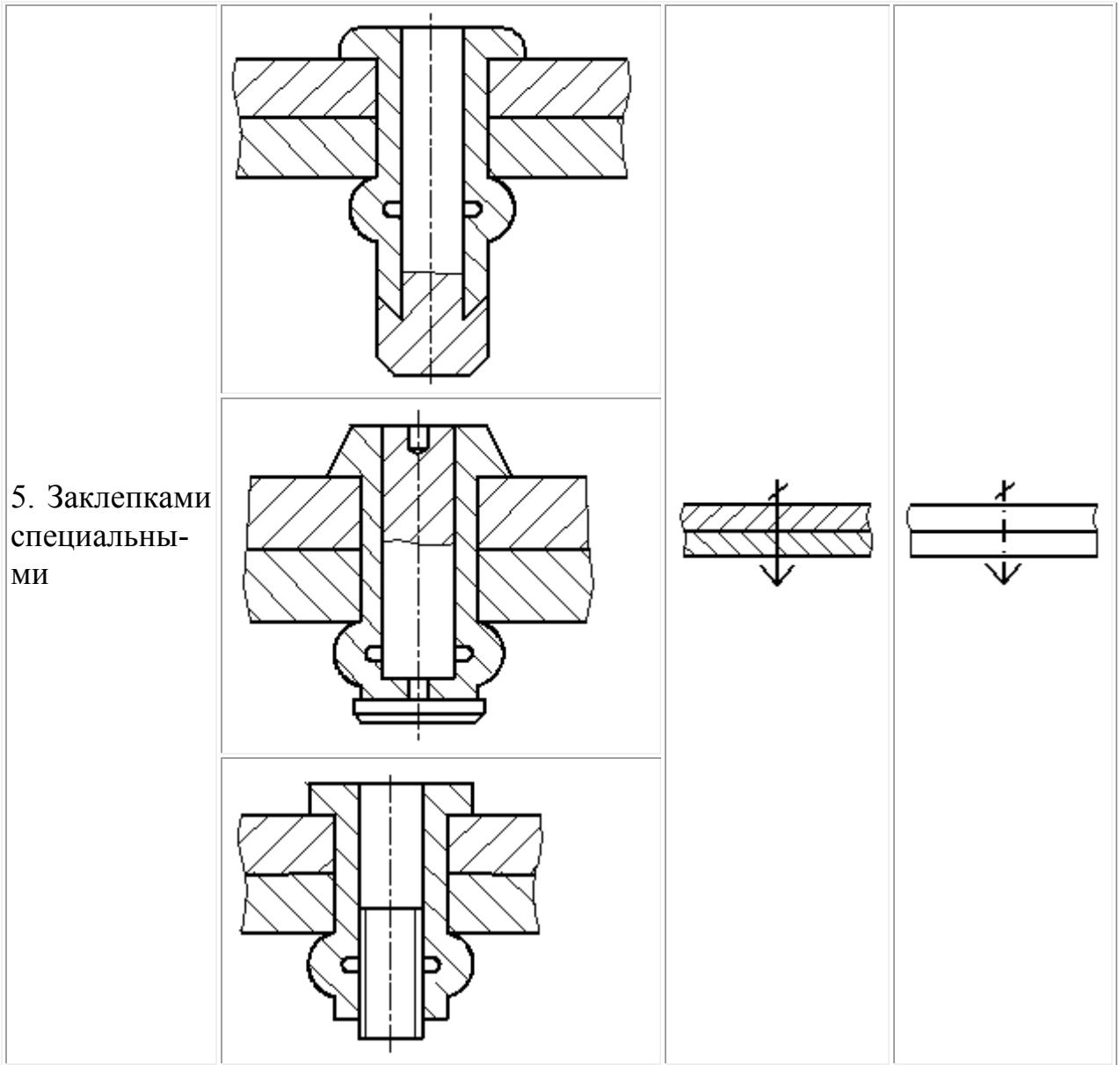
Если предмет, изображенный на сборочном чертеже, имеет ряд однотипных соединений с заклепками одного типа и с одинаковыми размерами, то заклепки, входящие в соединение, следует показать условно в одном-двух местах каждого соединения, а в остальных – центровыми или осевыми линиями (рисунок 3.48).
