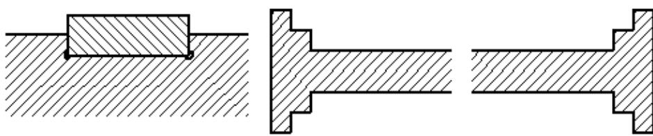
Рисунок 2.45 – Образцы изображения предметов, имеющих постоянное или закономерно изменяющиеся сечение.
