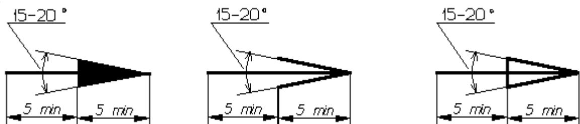
Рисунок 2.6 – Размеры стрелок, определяющих направление взгляда.
