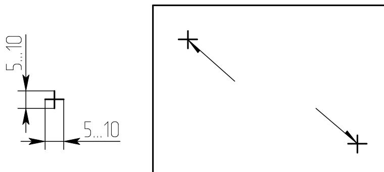
Рисунок 3.38 – Обозначение видимой одиночной сварной точки
