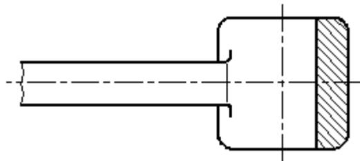
Рисунок 2.18 – Совмещение на изображении части вида и разреза.
