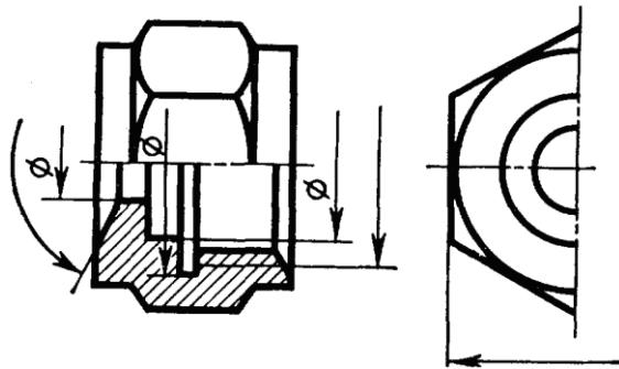
Рисунок 4.25 – Простановка размеров при соединении вида и разреза
