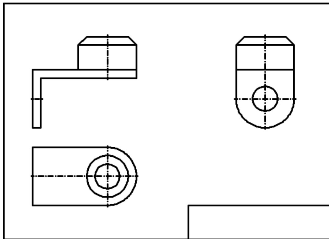
Рисунок. 4.4 – Шаг 2 построения эскиза кронштейна
