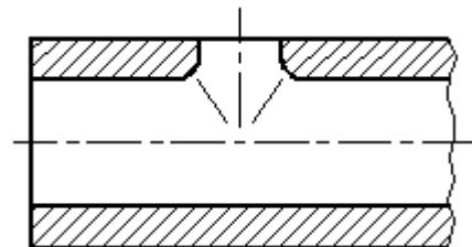
Рисунок 2.35 – Образец оформления линий плавного перехода поверхностей.
