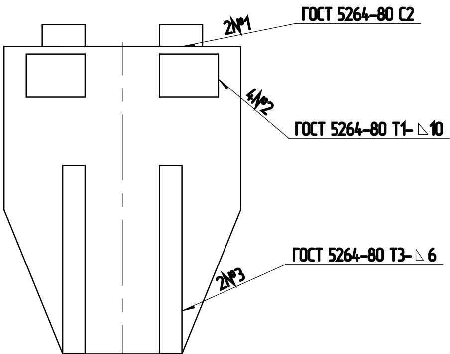
Рисунок 3.45 - Чертеж изделия с одинаковыми составными частями
