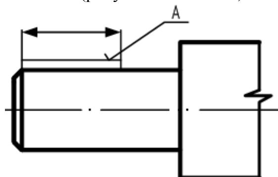
Рисунок 4.40 - Изображение покрытия
