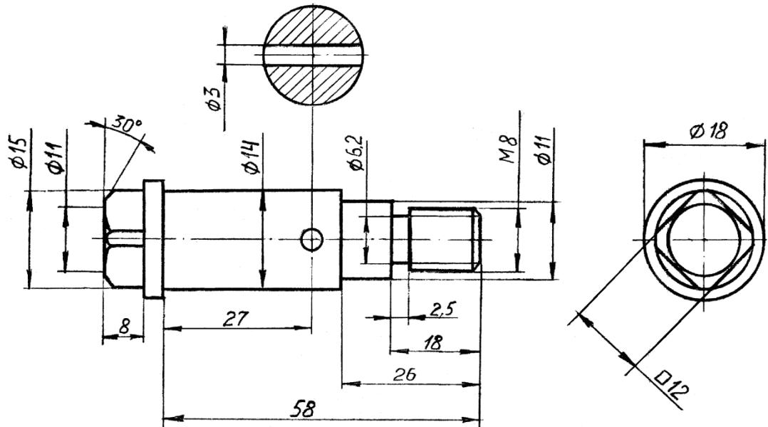
Рисунок 4.33 - Окончательный чертеж винта
