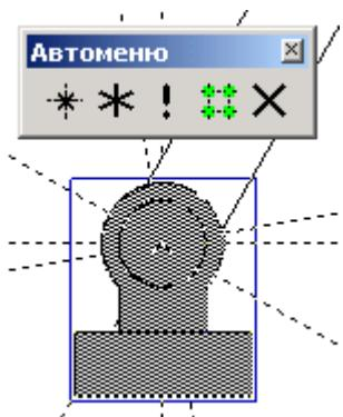
Рисунок 80 – Выбор фрагмента для отображения узлов
