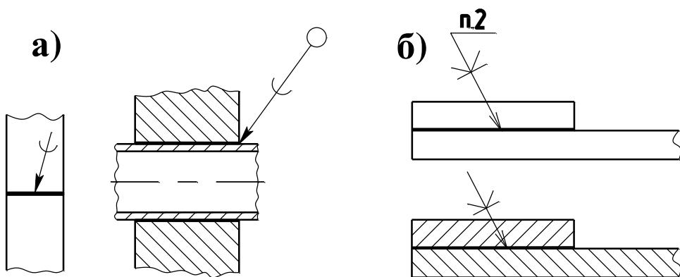
Рисунок 3.46 – Обозначение пайки
