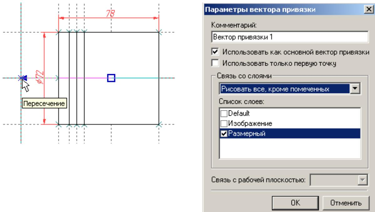
Рисунок 51 – Создание вектора привязки
