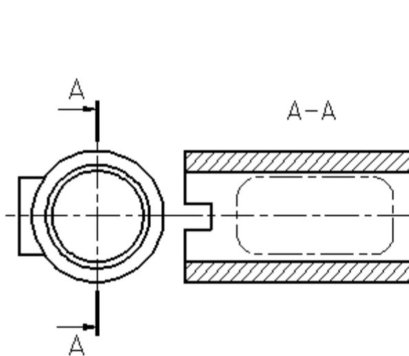
Рисунок 2.47 – Изображение части предмета, находящейся между наблюдателем и секущей плоскостью.
