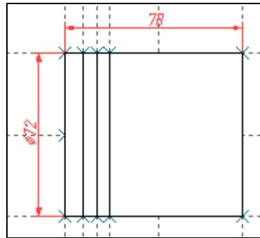
Рисунок 50 – Фрагмент-поршень
