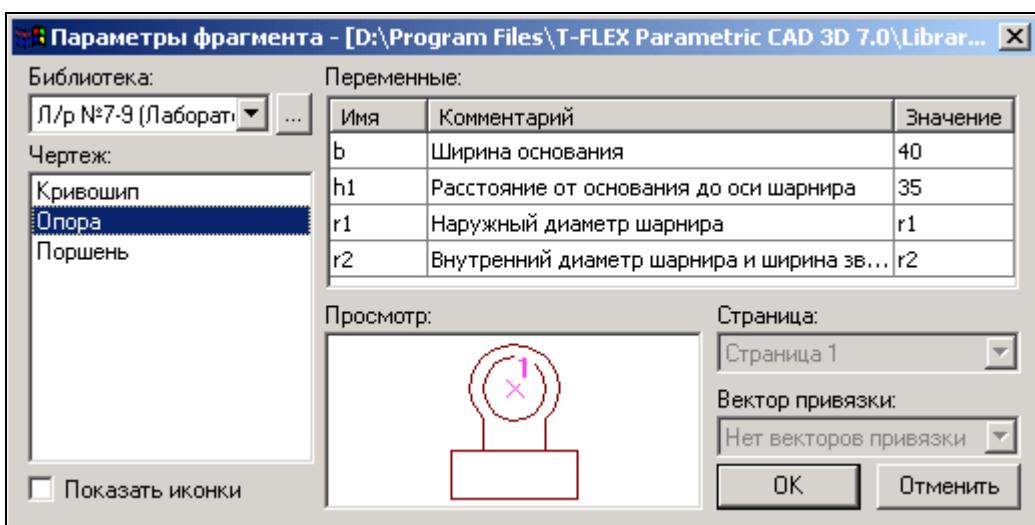
Рисунок 73 – Свойства фрагмента «Opora.grb»
