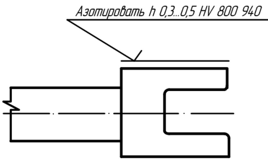
Рисунок 4.42 - Термической обработке подвергаются отдельные участки изделия
