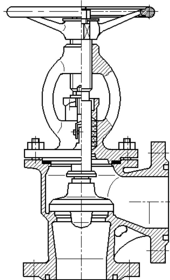
Рисунок 3. Пример оформления сборочного чертежа задвижки
