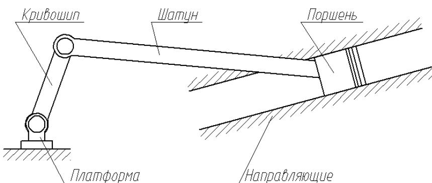
Рисунок 57 – Составляющие звенья кривошипно-шатунного механизма
