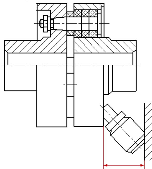
Рисунок 1 Сборочный чертеж муфты
