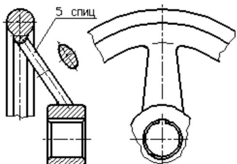
Рисунок 2.32 – Образец изображения равномерно расположенных элементов (5 спиц)
