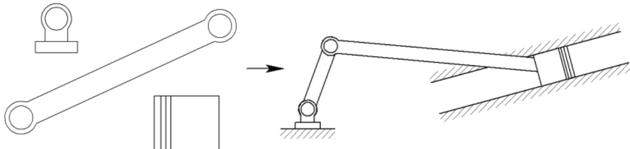
Рисунок 56 – Схема создания сборочного чертежа из фрагментов
