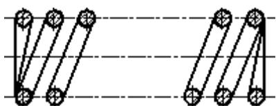
Рисунок 2.8 – Продольный разрез пружины.
