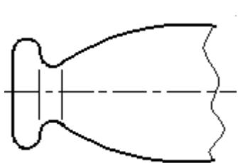
Рисунок 2.37 – Оформление плавного перехода 2
