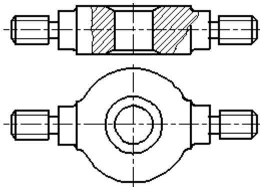
Рисунок 2.14 – Совмещение на изображении части вида и разреза.
