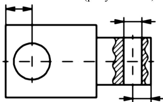
Рисунок 4.7 – Размеры отверстия
