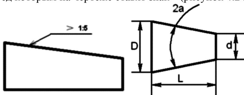
Рисунок 4.22 - Знак уклона  $\angle$
