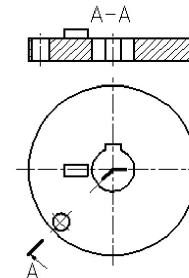
Рисунок 2.11 – Изображение элементов детали, расположенных за секущей плоскостью, при построении ломаного разреза.
