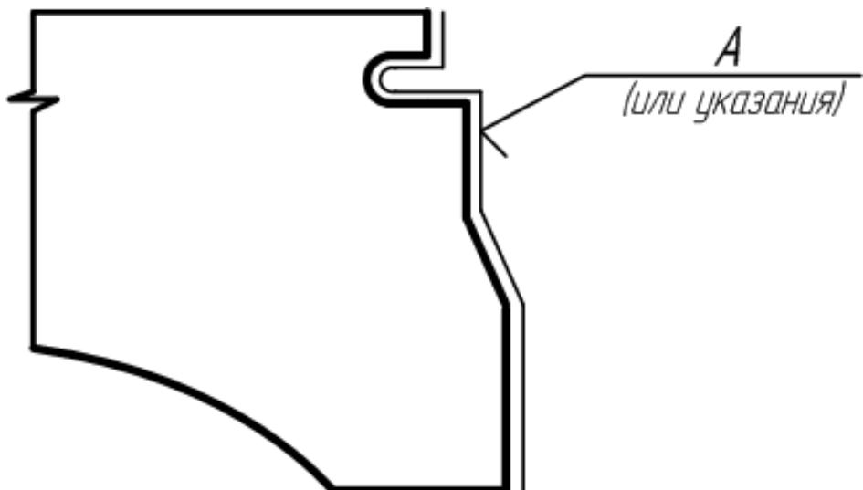
Рисунок 4.41 – Обозначение покрытия
