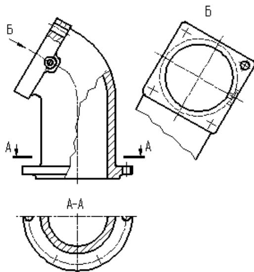
Рисунок 2.3 – Расположение и обозначение дополнительного вида.
