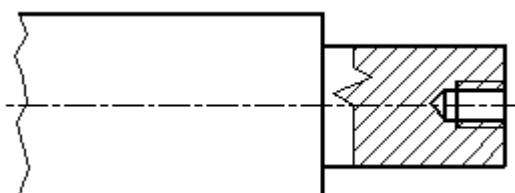
Рисунок 2.12 – Местный разрез, ограниченный сплошной волнистой линией.
