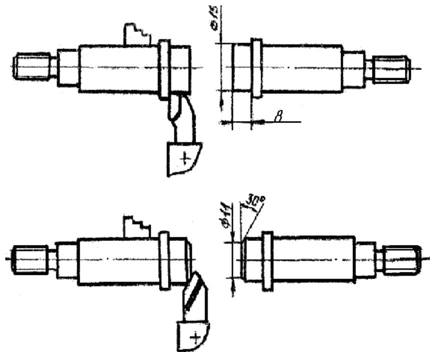
Рисунок 4.31 - Последовательность изготовления винта после переустановки
