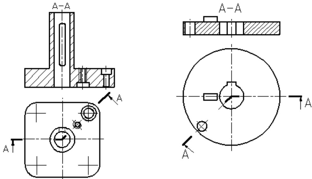
Рисунок 2.10 – Построение ломаного разреза.
