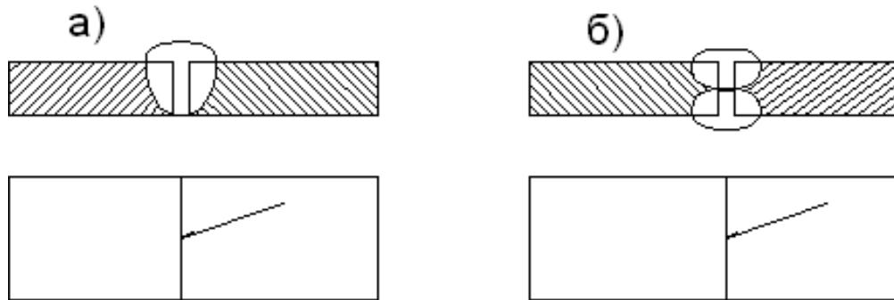
Рисунок 3.32 - Односторонние (а) и двухсторонние (б) швы
