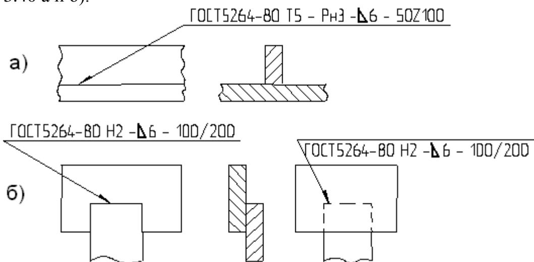
Рисунок 3.40 - Примеры обозначения сварных соединений по ГОСТ 2312-72
