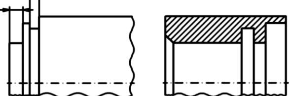
Рисунок 4.10 – Размеры проточки
