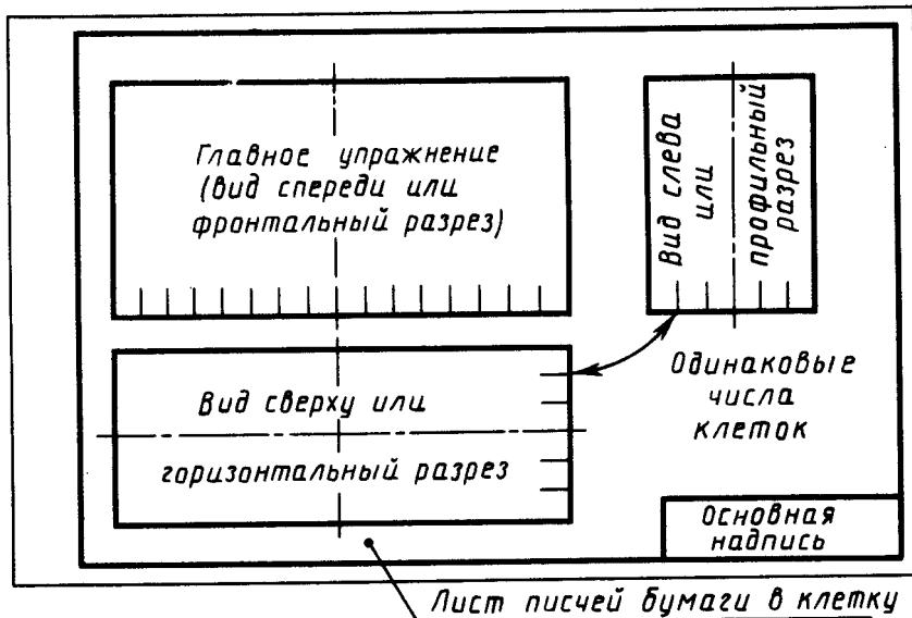
Рис. 4.43 – Схема компоновки
