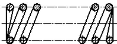
Рисунок 2.8 – Продольный разрез пружины.
