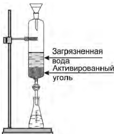
Рисунок 12. Установка для очистки воды адсорбцией
