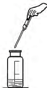
Рисунок 9. Соединение шприца-дозатора с пипеткой для титрования
