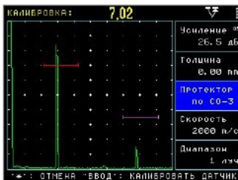
Рисунок 6.7 – Калибровка наклонного преобразователя по образцу СО-3
