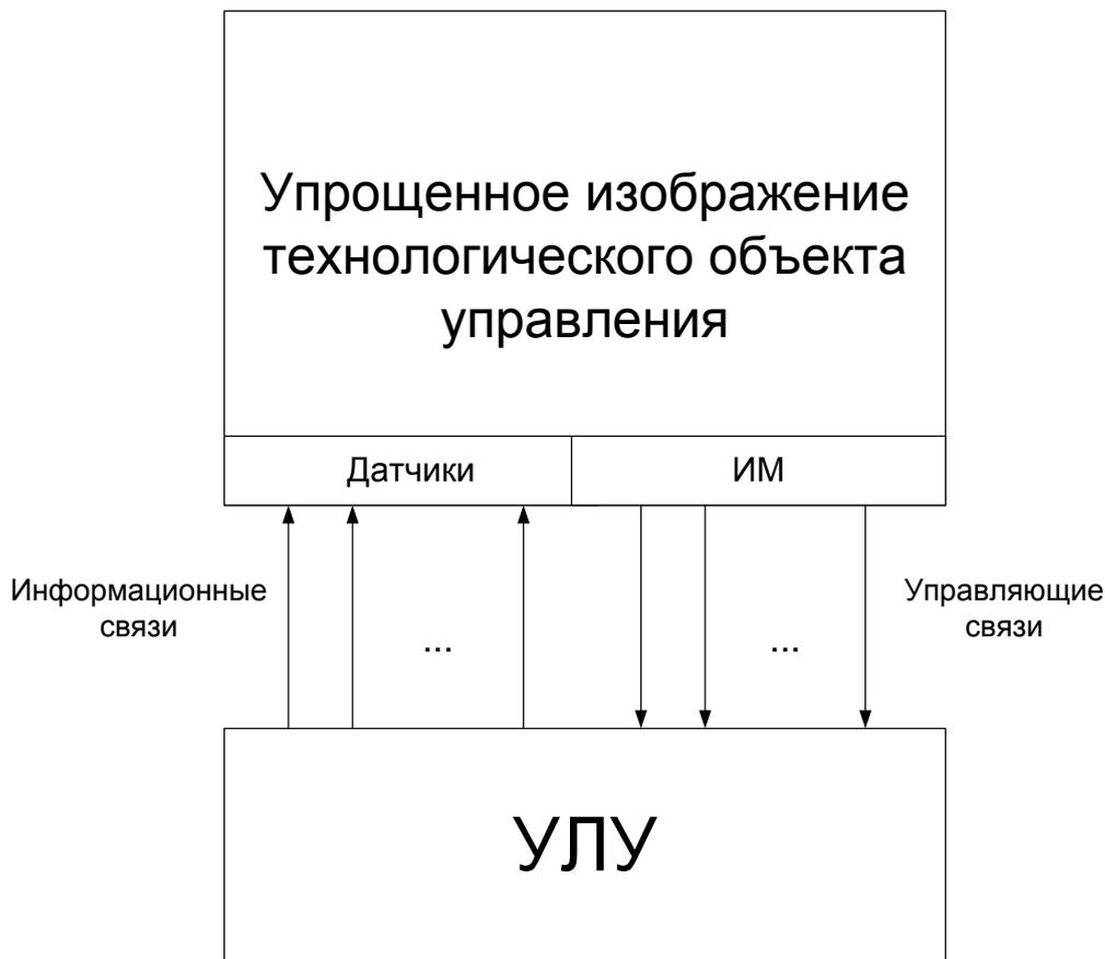
Рисунок 2. Структурная схема системы логического управления
