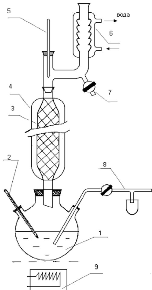
Рисунок 2.1 - Схема экспериментальной установки: 1 – куб; 2, 5 – термометры; 3 – колонна; 4 – внешняя ру-
