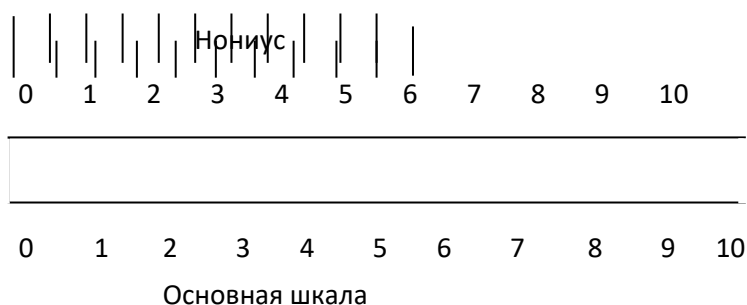
Рисунок 2.1 – Нониус и основная шкала
