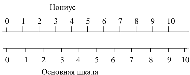
Рисунок 2.1 – Нониус и основная шкала
