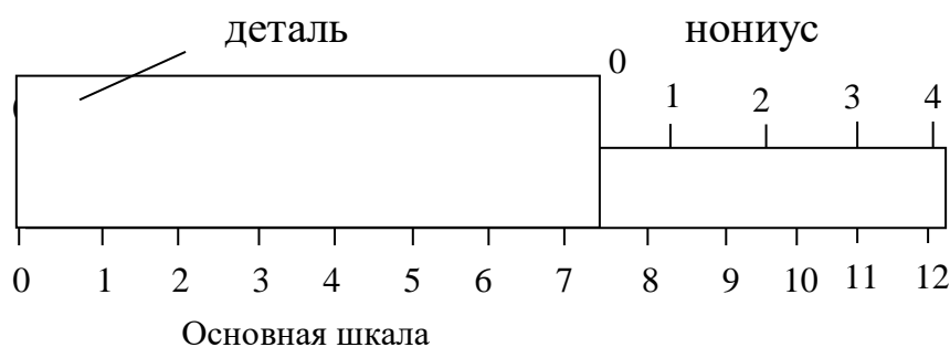
Рисунок 2.2 – Схема измерения детали
