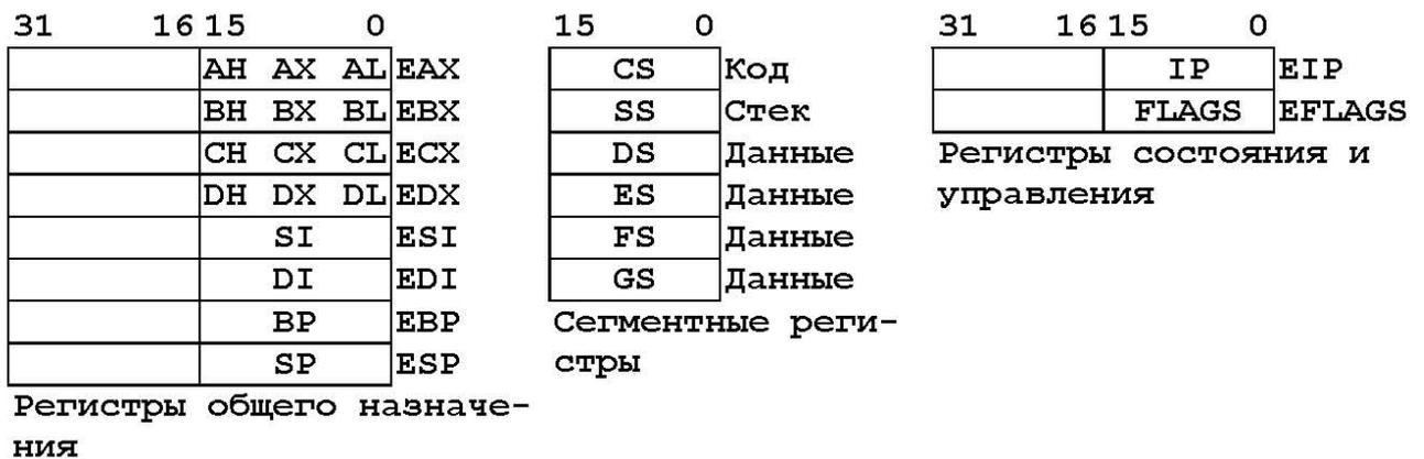
Рисунок 1.1 – Программная модель процессора семейства x86
