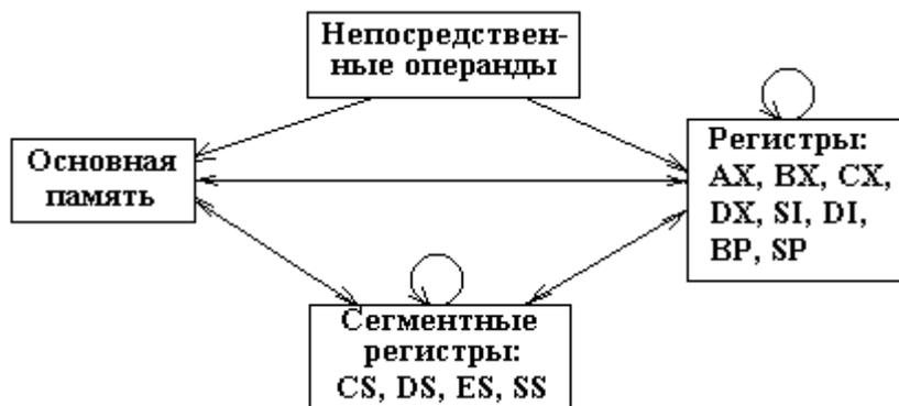
Рисунок 1.3 – Возможные пересылки
