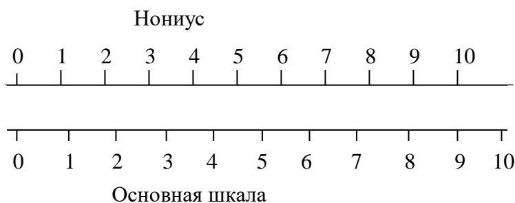
Рисунок 2.1 – Нониус и основная шкала
