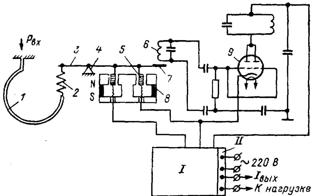
Рисунок 3.3 – Принципиальная схема пневмоэлектрического преобразователя ПЭ-55М
