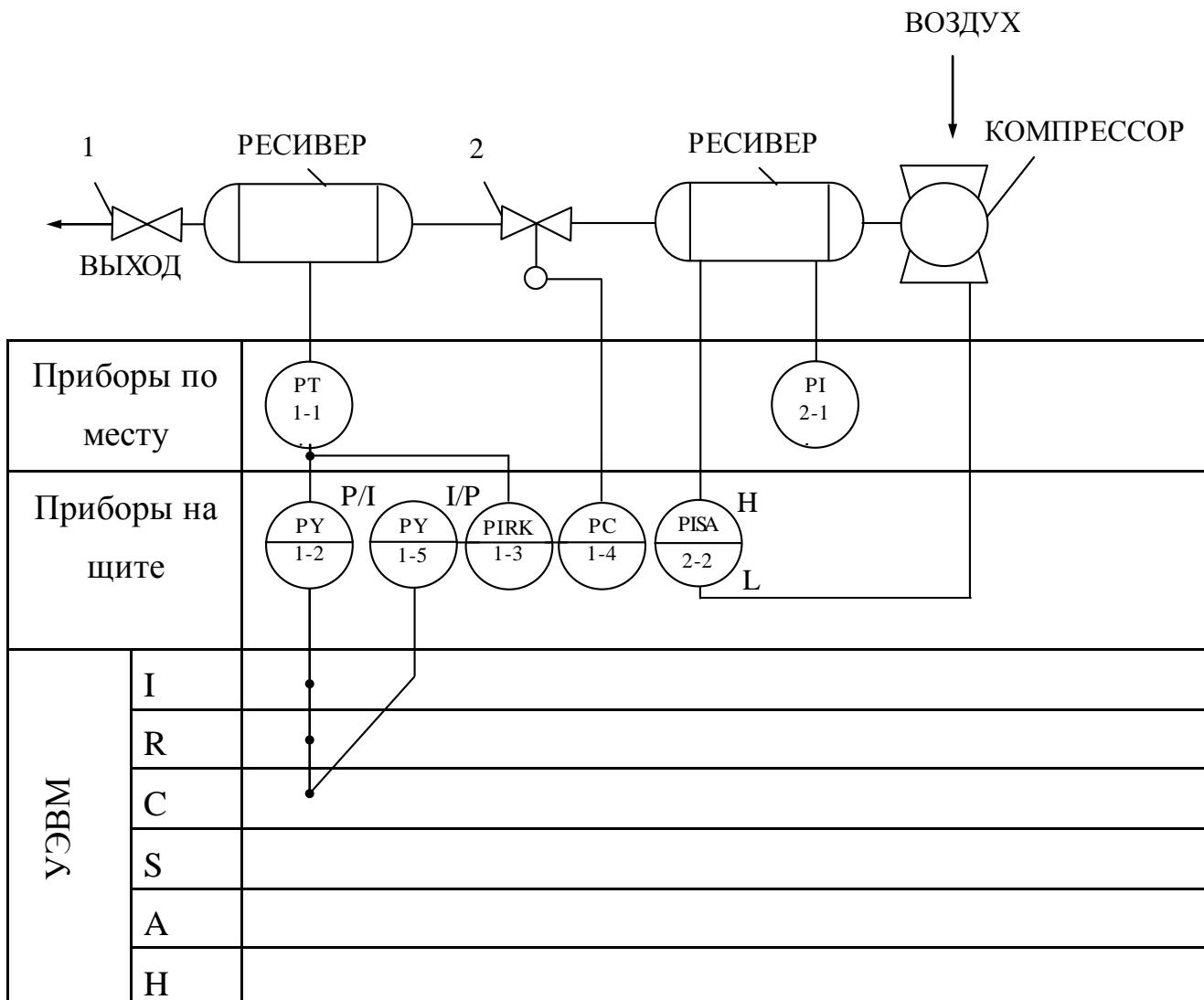
Рисунок 4.1 – Схема автоматизации процесса регулирования давления воздуха в ресивере,
