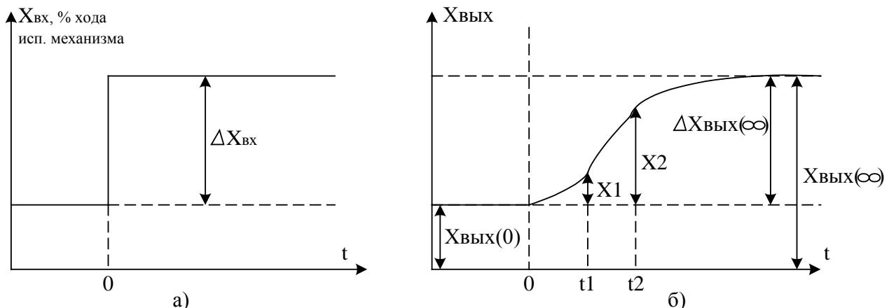
Рисунок 4.6 – Определение параметров объекта по кривой разгона
