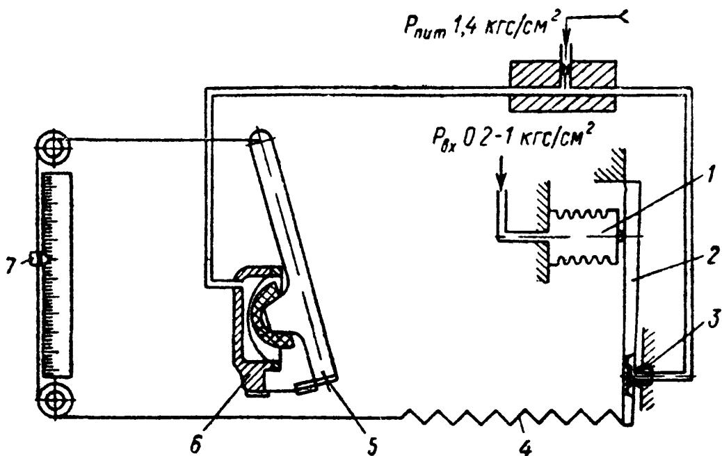
Рисунок 3.4 – Принципиальная схема вторичного показывающего прибора ПВ 4.1Э
