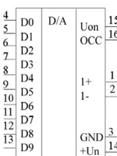
Рисунок 4.10 – Микросхема К572ПА1А
