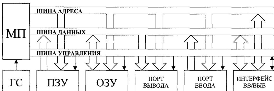
Рисунок. 2.1 Структурная схема микропроцессорной системы.
