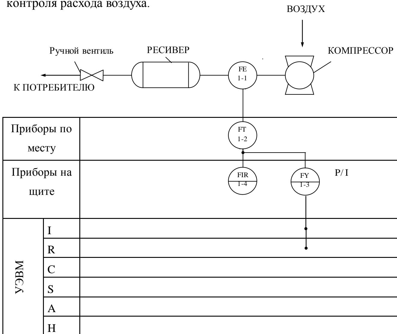
Рисунок 3.1 – Схема автоматизации процесса измерения расхода воздуха
