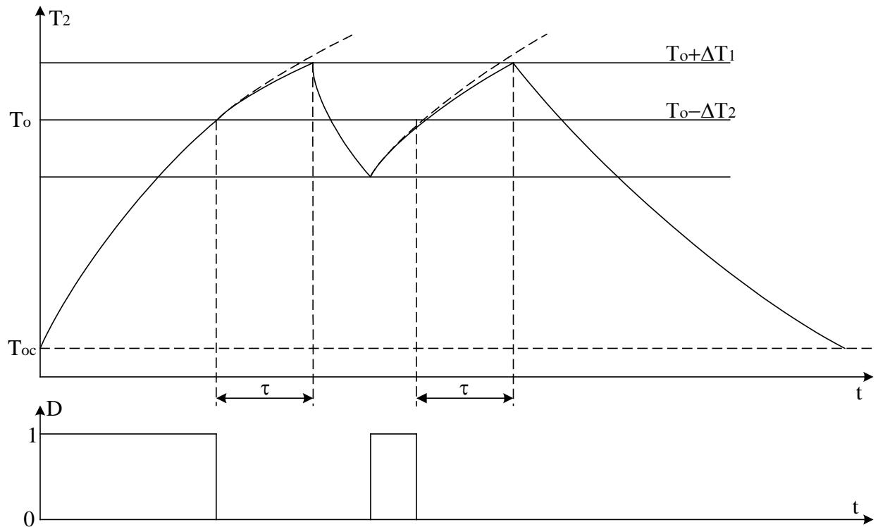
Рисунок 1.3 – График изменения температуры объекта и состояния регулятора
