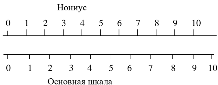
Рисунок 2.1 – Нониус и основная шкала
