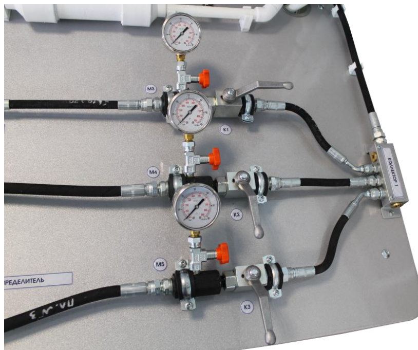
Рисунок 4 - Группа манометров и шаровых кранов на выходе напорных магистралей
