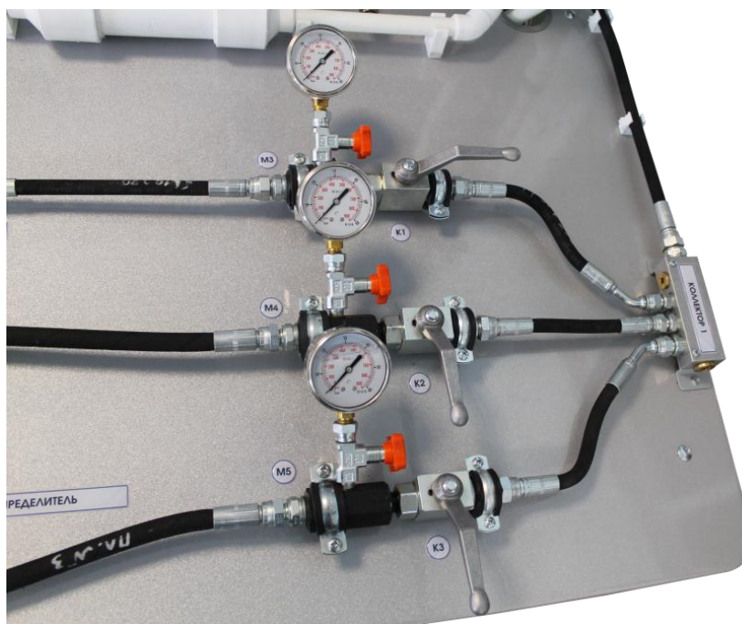
Рисунок 4 - Группа манометров и шаровых кранов на выходе напорных магистралей
