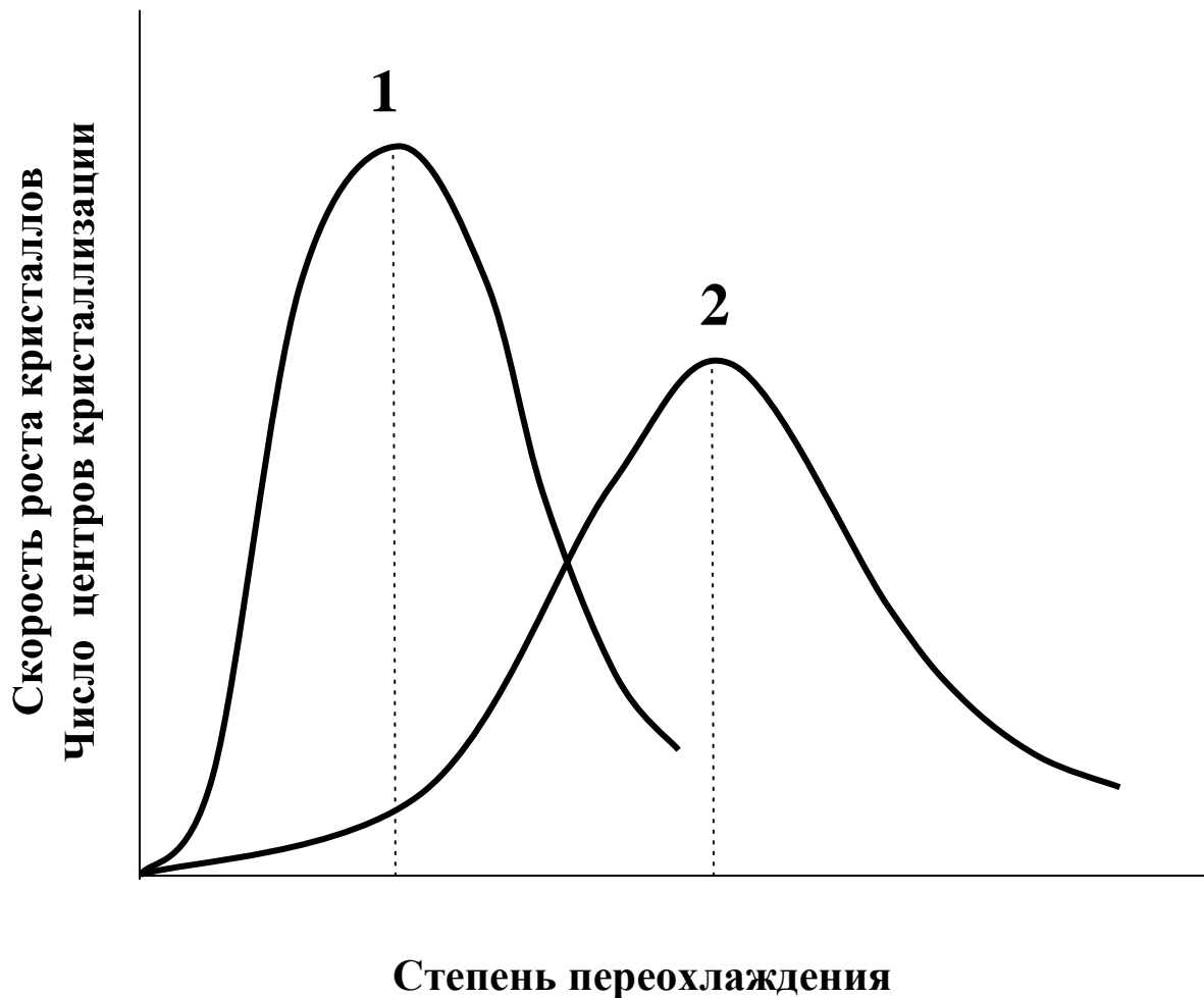
Рис. 3. Скорость роста кристаллов (1) и число центров кристаллизации (2) в зависимости от степени переохлаждения металла
