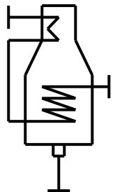
б) с вертикальными радиантными трубами
