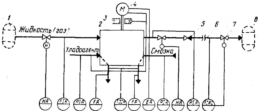
Рисунок А.2 – Схема автоматизации процесса перемещения жидкости:
