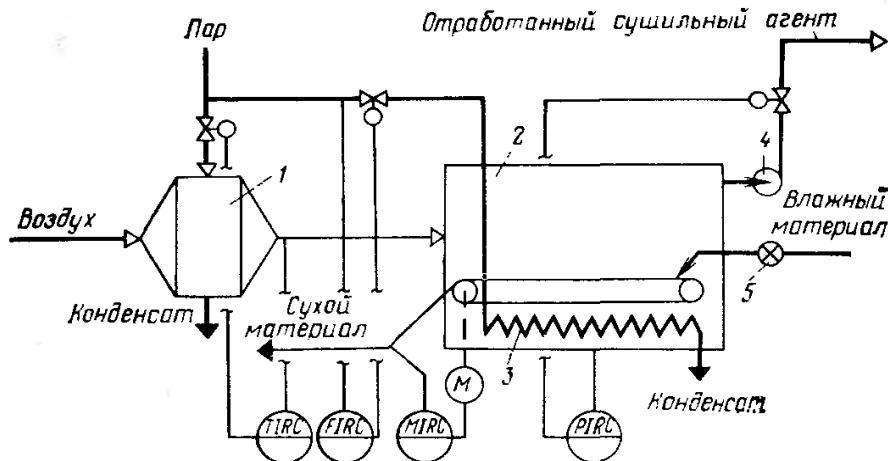
Рисунок А.15 – Схема автоматизации ленточной (конвейерной) сушилки:
