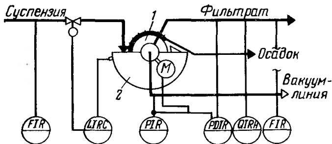
Рисунок А.18 – Схема автоматизации процесса фильтрования жидкого сырья:
