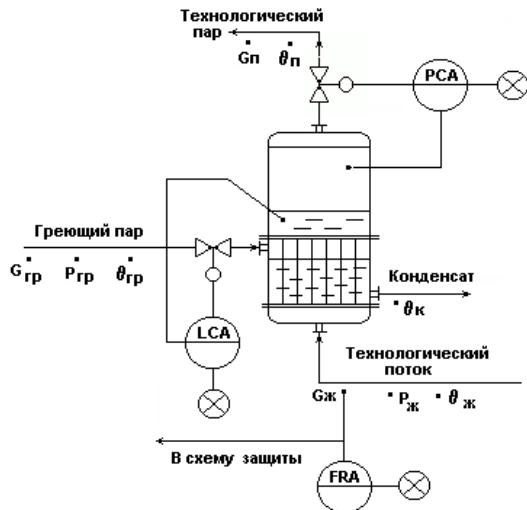
Рисунок А.4 – Схема автоматизации испарителя (кожухотрубного теплообменника с изменяющимся агрегатным состоянием теплоносителя и технологического потока)
