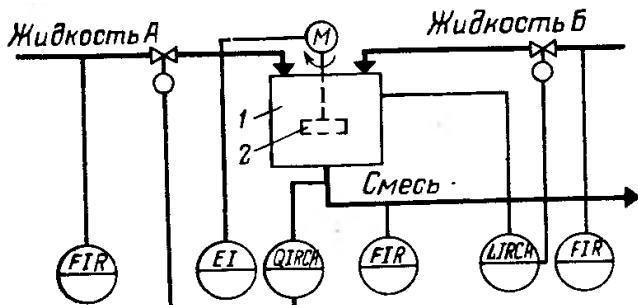
Рисунок А.13 – Схема автоматизации процесса смешения жидкостей:
