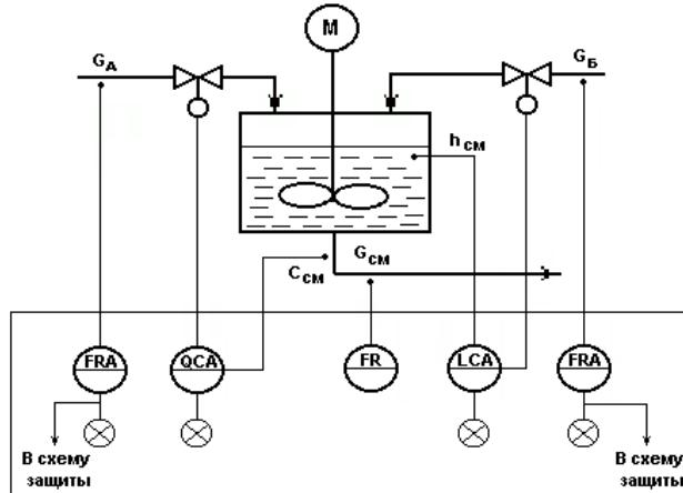
Рисунок А.1 – Схема автоматизации емкости с мешалкой (аппарата непрерывного действия), в которой смешиваются две жидкости *А* (с концентрацией целевого компонента  $C_a$ ) и *Б* (с концентрацией целевого компонента  $C_b$ ) для получения гомогенизированного раствора с заданной концентрацией целевого компонента  $C_{cm}$
