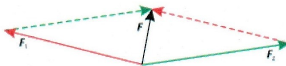
Рисунок 4.1 – Векторная сумма сил (параллелограмм сил)
