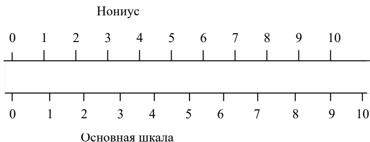
Рисунок 2.1 – Нониус и основная шкала
