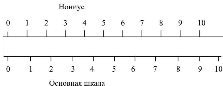
Рисунок 2.1 – Нониус и основная шкала
