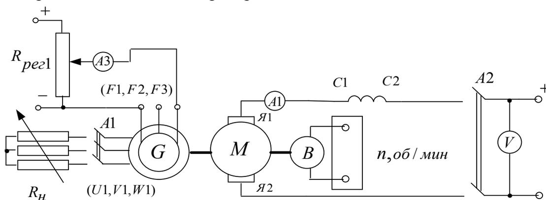
Рисунок 2.5.3 Принципиальная электрическая схема для снятия механических характеристик двигателя постоянного тока с последовательным возбуждением: G- синхронный генератор; М- машина постоянного тока (двигатель); Я1-Я2- концы якорной обмотки; С1-С2- концы серийной (последовательной) обмотки возбуждения;  $R_{рег1}$  - регулировочный реостат; В- тахогенератор.
