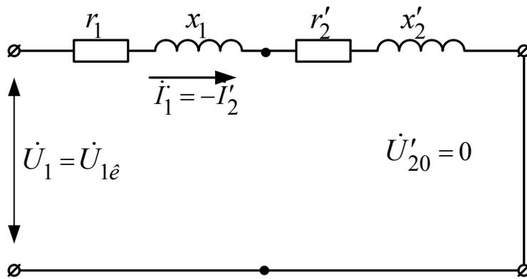
Рисунок 4.1.6 – Схема замещения трансформатора в режиме короткого замыкания
