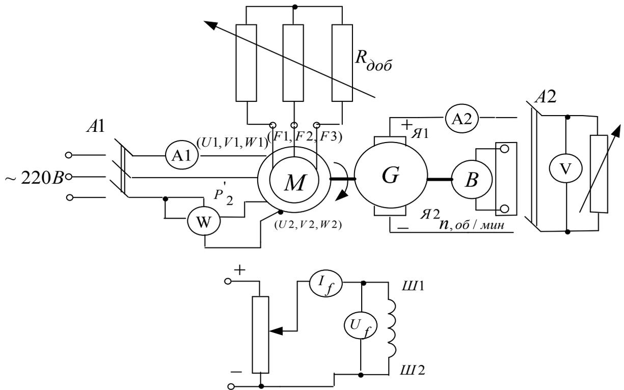
Рисунок 3.4.2 Принципиальная электрическая схема для снятия рабочих характеристик асинхронного двигателя с фазным ротором
