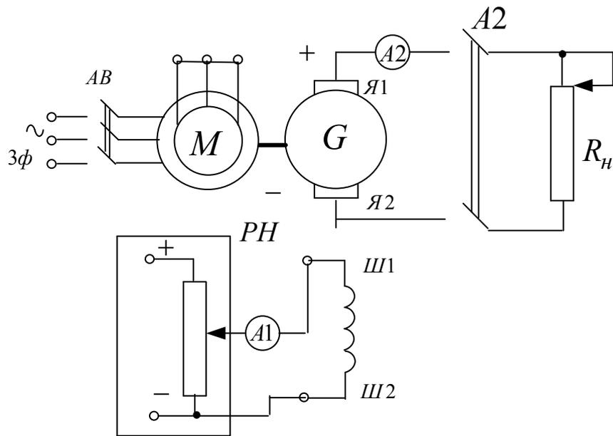
Рисунок 2.2.3 – Принципиальная электрическая схема опыта короткого замыкания генератора постоянного тока с независимым возбуждением. М – приводной асинхронный электродвигатель; G – машина постоянного тока (генератор); Я1-Я2 – концы якорной обмотки; Ш1-Ш2 – концы шунтовой (параллельной) обмотки возбуждения;  $R_n$  – нагрузочный реостат; PH – регулятор напряжения
