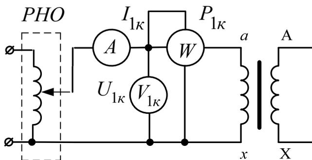
Рисунок 4.1.5 – Принципиальная схема опыта короткого замыкания
