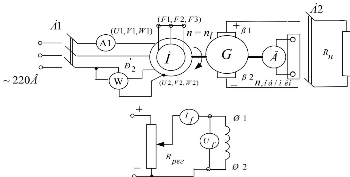
Рисунок 3.3.1 Принципиальная электрическая схема для определения механической характеристики  $n=F(M)$  (короткозамкнутый ротор): М-асинхронный двигатель; G- машина постоянного тока (генератор); Я1-Я2-концы якорной обмотки; Ш1-Ш2- концы шунтовой (параллельной) обмотки возбуждения;  $R_{рег}$ - регулировочный реостат; В- тахогенератор;  $R_H$ -реостат нагрузки генератора
