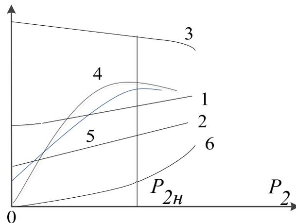
Рисунок 3.4.3 Примерный вид рабочих характеристик асинхронного двигателя:
