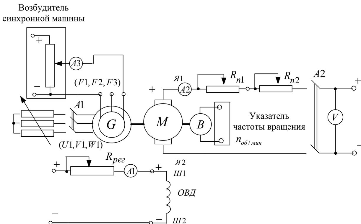
Рисунок 2.4.1 Принципиальная электрическая схема для снятия пусковых характеристик двигателя постоянного тока с независимым возбуждением. G- синхронный генератор; M- машина постоянного тока (двигатель); Я1-Я2- концы якорной обмотки; Ш1-Ш2- концы шунтовой (параллельной) обмотки возбуждения; R<sub>н</sub>- нагрузочный реостат; R<sub>рег</sub> - регулировочный реостат; R<sub>н1</sub>, R<sub>н2</sub> - пусковые реостаты
