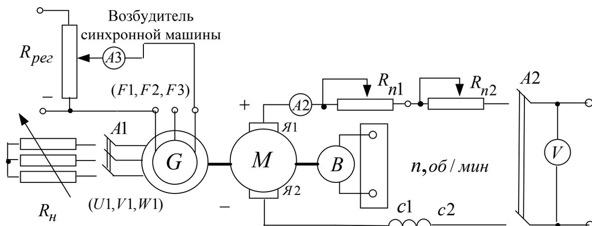
Рисунок 2. 4.3 Принципиальная электрическая схема для снятия пусковых характеристик двигателя постоянного тока с последовательным возбуждением. G- синхронный генератор; М- машина постоянного тока (двигатель); Я1-Я2- концы якорной обмотки; Ш1-Ш2- концы шунтовой (параллельной) обмотки возбуждения; R<sub>н</sub>- нагрузочный реостат; R<sub>рег</sub> - регулировочный реостат; R<sub>n1</sub>, R<sub>n2</sub> - пусковые реостаты
