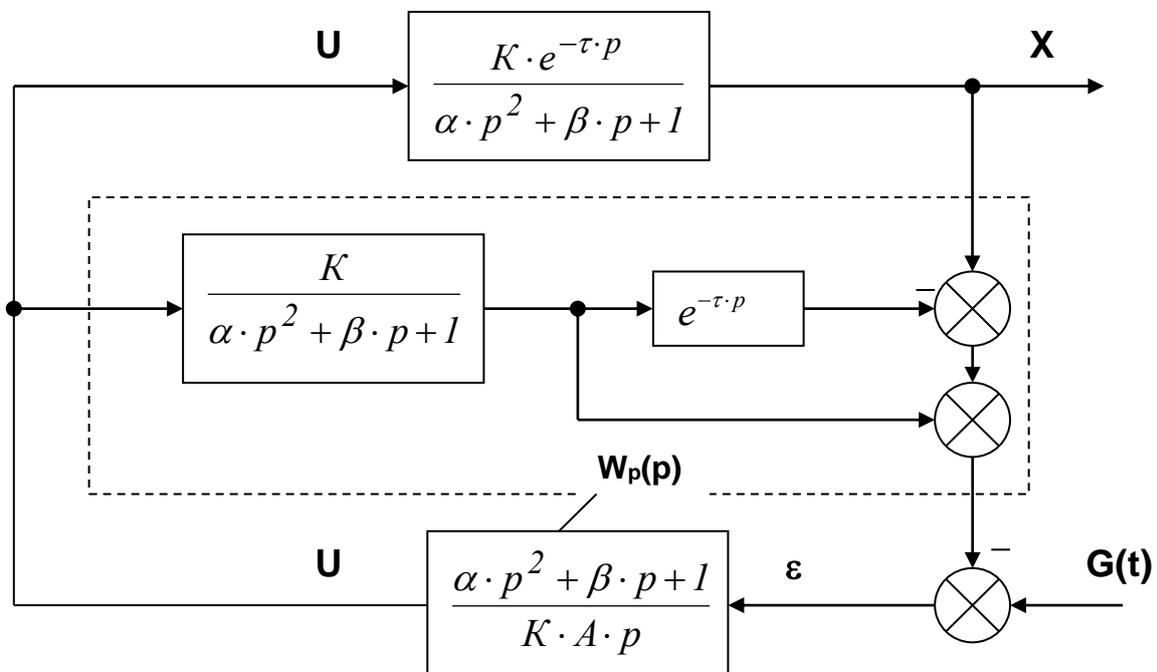
Рисунок 3 – Схема, реализующая оптимальный регулятор
