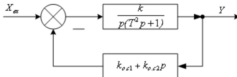
Рисунок 6.4 – Структурная схема оптимальной по точности системы
