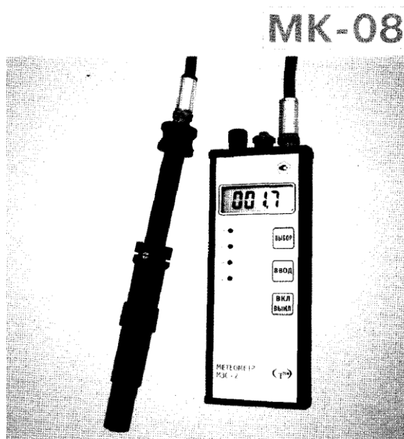
Рисунок 2 – Универсальный метеометр «МЭС –2».
