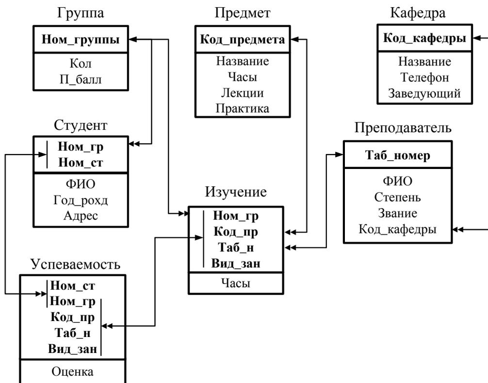
Рисунок 1.3 – Логическая структура реляционной базы данных
