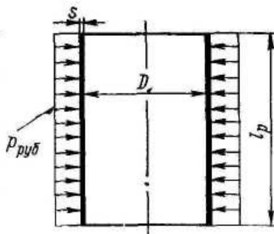
Рисунок 4 – Расчетная схема цилиндрической обечайки, нагруженной наружным давлением
